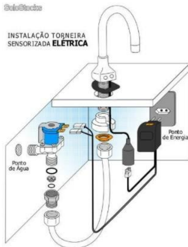
Figura 4 – Detalhe de instalação de torneira com sensor automático
