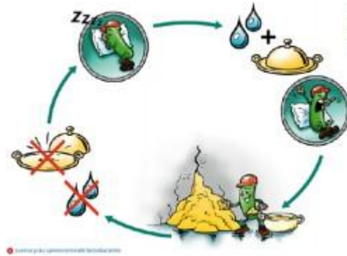
Figura 12 – Processo de auto cura do concreto
