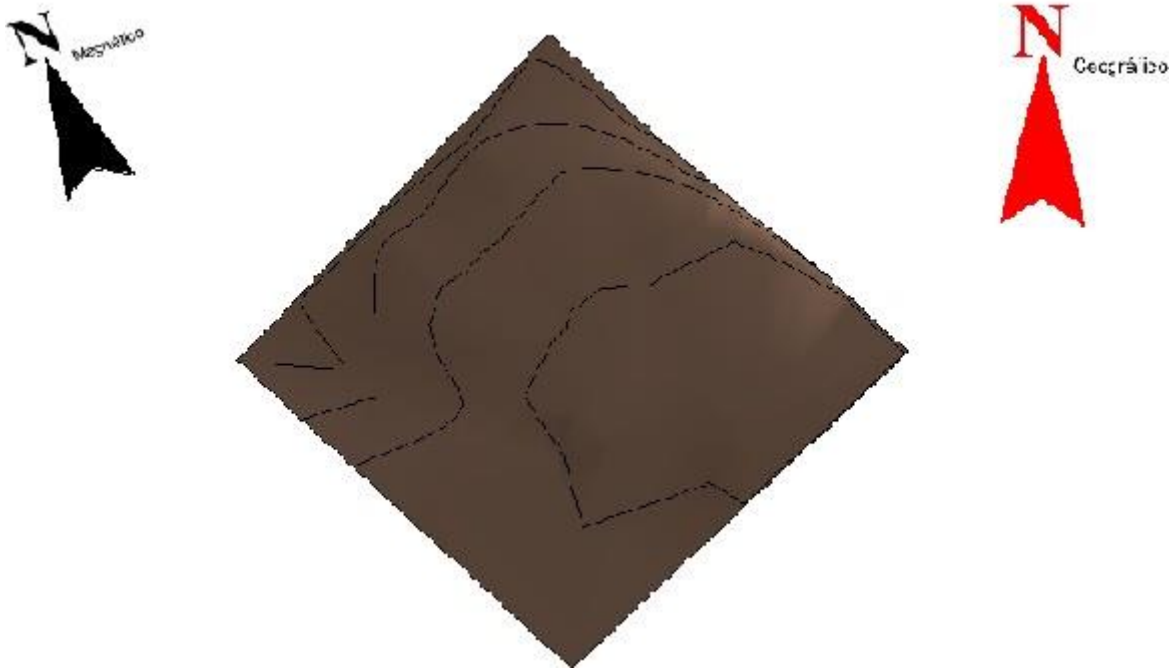
Figura 17 – Curvas de nível do terreno, com indicação dos nortes geográfico, em vermelho, e magnético, em preto
