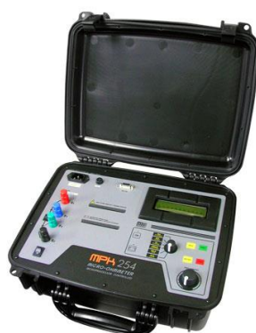
Figura 34 – Microhmímetro Megabras MPK 254
