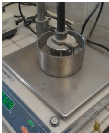
Figura 10 - Densitômetro de mercúrio para medir a densidade.
