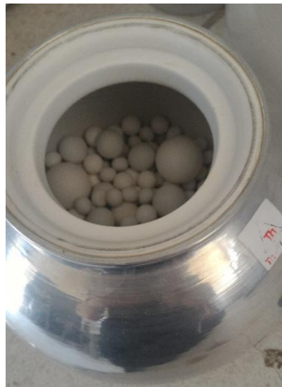
Figura 8 - Recipiente contendo material e água a ser colocado no misturador.
