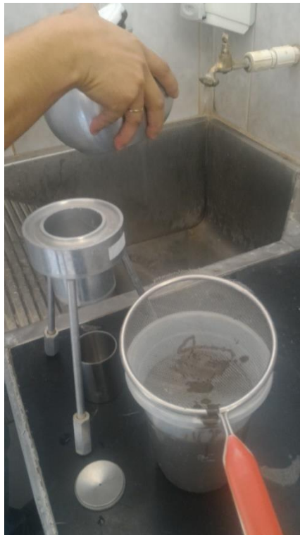
Figura 9 - Viscosímetro copo Ford utilizado para o escoamento das amostras.
