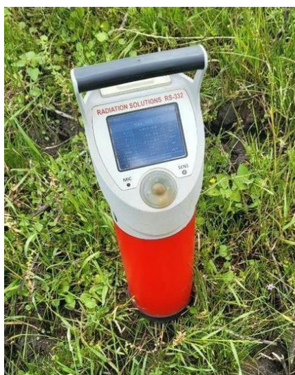
Figura 11 - Gamaespectrômetro RS-332 usado no levantamento geofísico.
