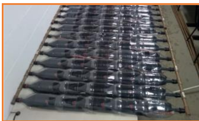
Figura 9 – Painel solar após os últimos encaixes/Próprio autor
