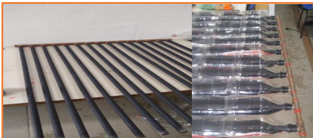
Figura 8 – Bastões das colunas encaixados no barramento superior e garrafas fixadas com a fita isolante/Próprio autor
