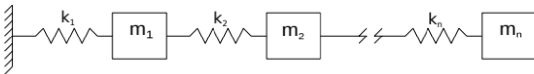
Figura 14 – Sistema massa-mola com vários graus de liberdade.
