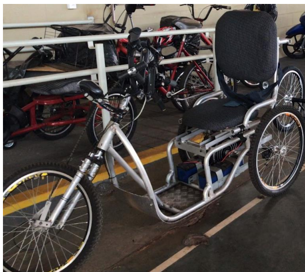
Figura 7 – Triciclo elétrico o qual traciona a Carruagem da Alegria.
