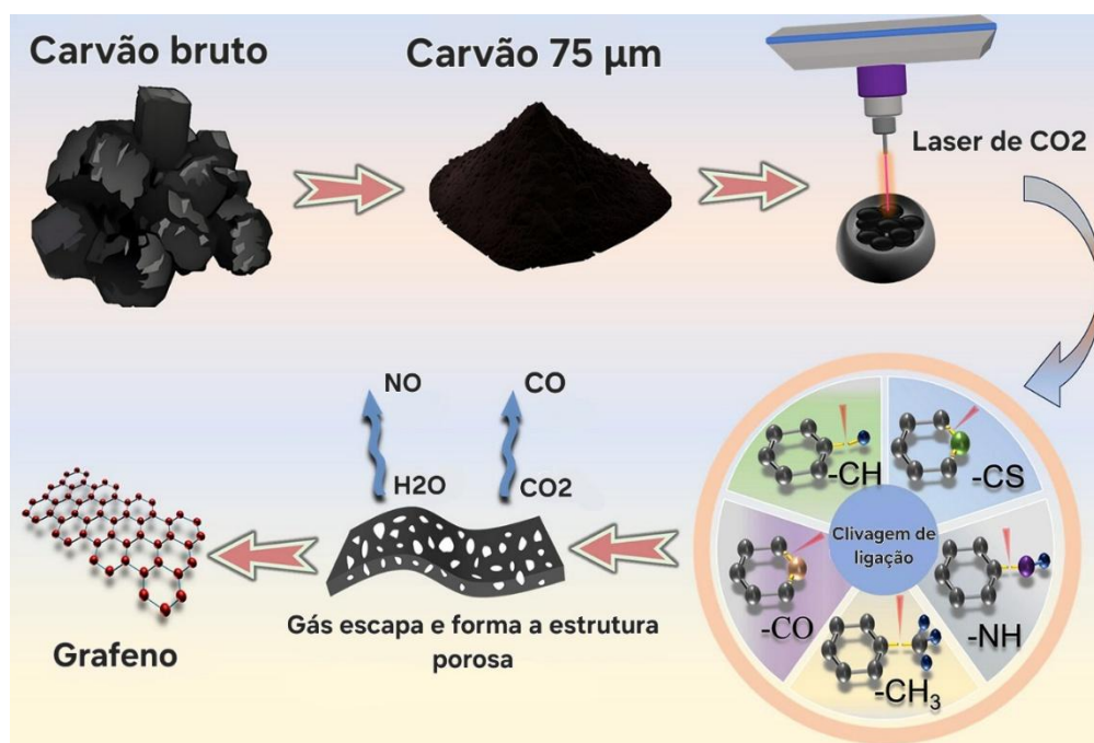
Figura 6: Esquema de formação de grafeno de poucas camadas induzida por laser a partir de carvão. Retirado de Ma et al. (2025) [64].
