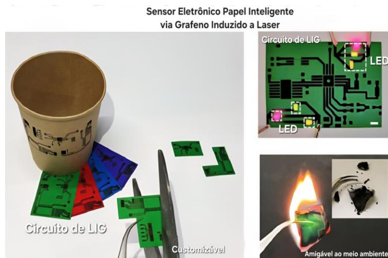
Figura 7: Copo de papel com sensores LIG para monitorar a qualidade do conteúdo, demonstrando propriedades chave do LIG, como fácil customização, condutividade e sustentabilidade. Retirado de Jung et al. (2022) [71].
