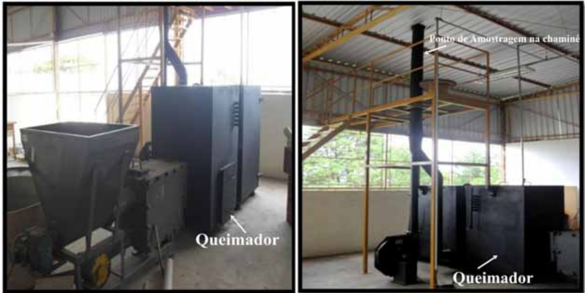
Figura 3: Câmara de combustão (queimador aberto) e chaminé de amostragem acoplada à estufa de secagem a ar quente.
