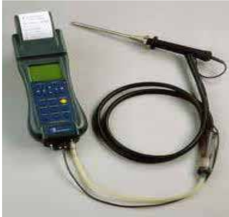
Figura 6: Eurotron Ecoline 4000 para amostragem de gases.
