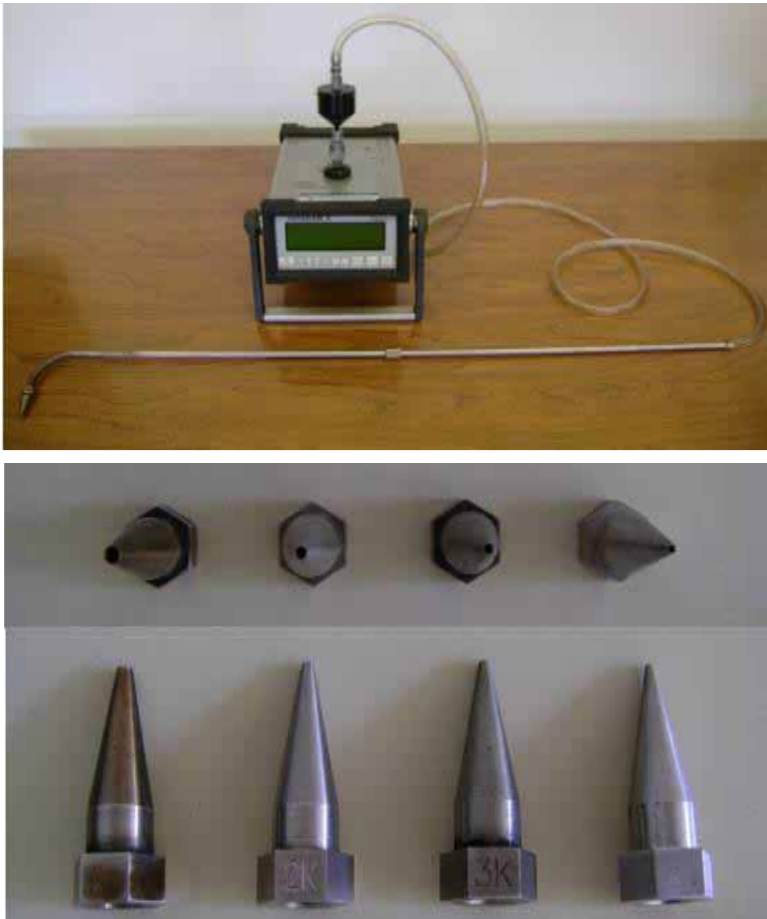
Figura 5: DATARAM acoplado à sonda de amostragem e bocais para amostragem.
