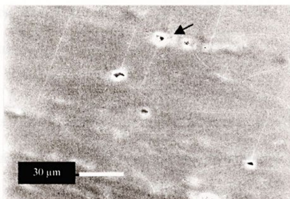
FIGURA 30 - Superfície do cdp "d" (fig. 27) (40 minutos), mostrando a presença de porosidades associadas à microtrinca.
