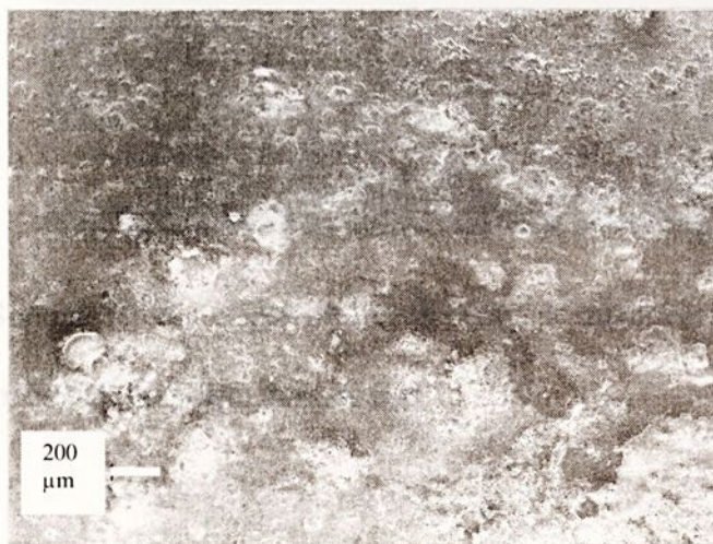
FIGURA 41 - Superfície do corpo de prova sem anodização, mostrando a presença de corrosão generalizada.
