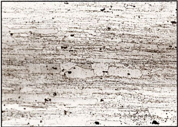
FIGURA 20 - Fotomicrografia da liga de alumínio como fornecida. Seção longitudinal. Aumento: 200x. Ataque: Ferricianeto de potássio + hidróxido de sódio.
