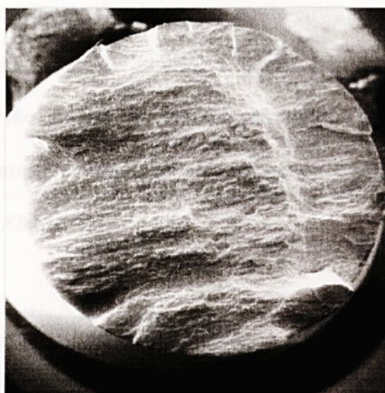
FIGURA 33 - Superfície de fratura do corpo-de-prova sem anodização (seção longitudinal). Nota-se que os inícios de propagação das trincas partem da superfície do corpo de prova. O nível de tensão máxima aplicado foi de 35% da \sigma_e (166,94 MPa).
