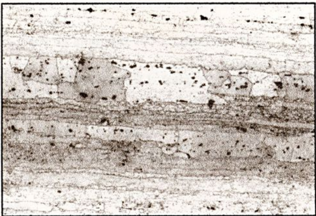
FIGURA 19 – Fotomicrografia da liga de alumínio como fornecida. Seção transversal. Aumento: 200x. Ataque: Ferricianeto de potássio + hidróxido de sódio.
