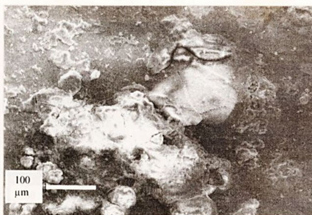
FIGURA 42 - Detalhe da figura anterior, mostrando produtos de corrosão.
