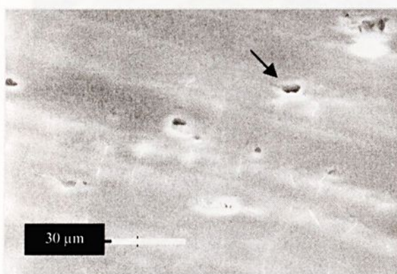
FIGURA 31 - Superfície do cdp "d" (fig. 27) (40 minutos). Outra região apresentando porosidades associadas a microtrincas.
