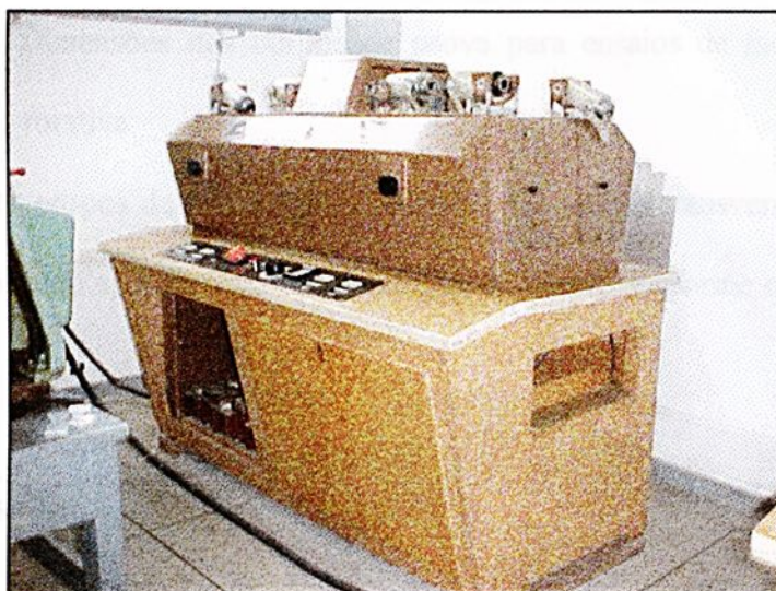
FIGURA 16 - Máquina de ensaios de fadiga por flexão rotativa.
