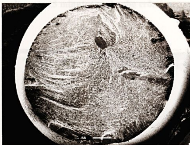
FIGURA 36 - Superfície de fratura de corpo-de-prova anodizado, mostrando múltiplos inícios de trincas (seção longitudinal). Tempo de imersão no processo de banho eletrolítico em ácido crômico: 40 minutos. O nível de tensão máxima aplicada foi de 60% de \sigma_e (286,19 MPa).
