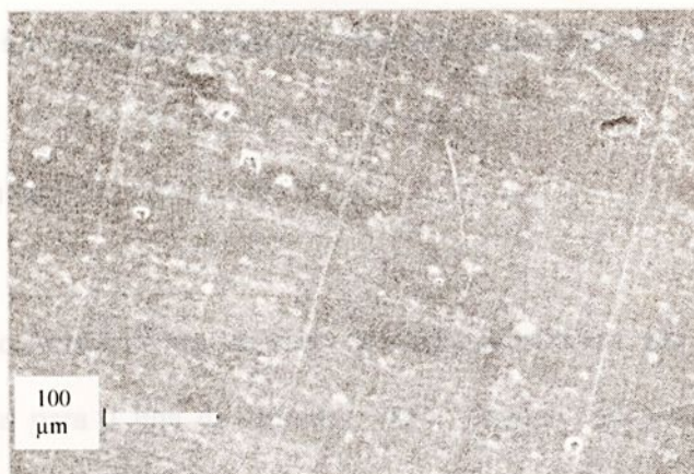
FIGURA 44 – Não se observa a presença de corrosão. Verifica-se a presença de porosidades.
