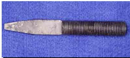
FIGURA 15 – Cinzel utilizado para o cisalhamento dos corpos-de-prova.
