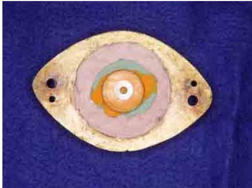
FIGURA 13 – Centralização da etiqueta adesiva no molde.
