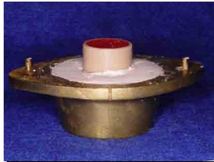
FIGURA 4 – Anel de PVC incluído em gesso na mufla metálica.
