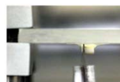
Secção transversal de 1 mm/bloco. Obtenção do bloco 4x3x3 mm.
