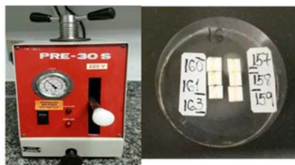
Metade de cada bloco foi embutido com identificação em resina acrílica
