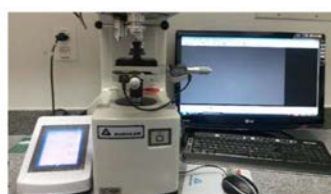
Dureza inicial do esmalte. Carga estática – 25 g. Tempo – 10 s.
