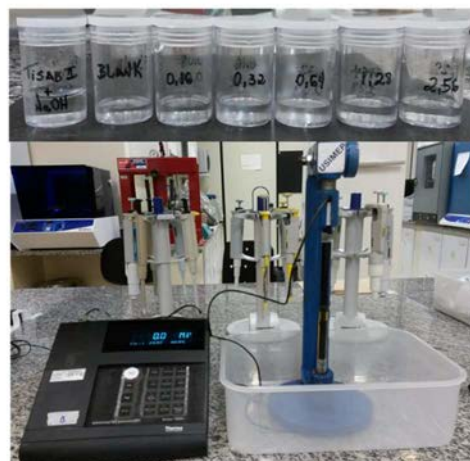
Eletrodo específico Orion 9409-BN e microeletrodo de referência, acoplados ao analisador de íons Orion 720 A, para a leitura de F presente no esmalte
