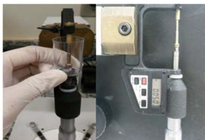
Microabrasão. Remoção de uma camada de 50 \mu\text{m} com lixa adesiva de granulação 400 adaptada ao frasco J-10.
