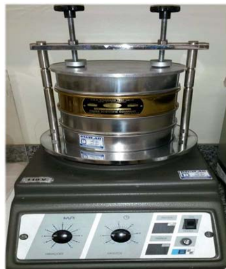
Peneiras granulométricas acopladas ao agitador eletromagnético para padronização das partículas de TMPm ( <53 \mu\text{m} ).
