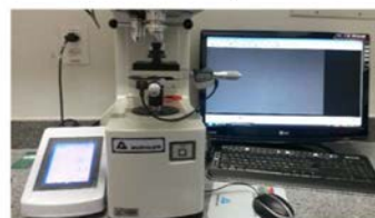
Dureza longitudinal. Carga estática de 5 g. Tempo de 10 s.
