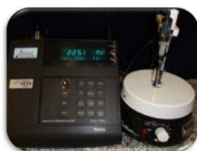
Eletrodo específico para íon F. Leituras realizadas sob agitação constante
