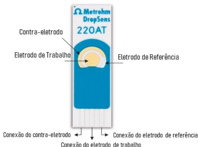
Figura 17. Modelo do Sensor de Ouro Serigrafado Metrohm DropSens 220AT utilizado nos experimentos. São indicadas as localizações dos eletrodos de trabalho (ouro), referência (prata) e contra-eletrodo (ouro), bem como suas respectivas conexões com o Potenciostato Palm-Sens Sensit BT.
