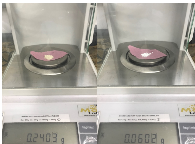
Figura 6 - Pó de vidro com prata e glaze sendo medidos em balança de precisão, respectivamente
