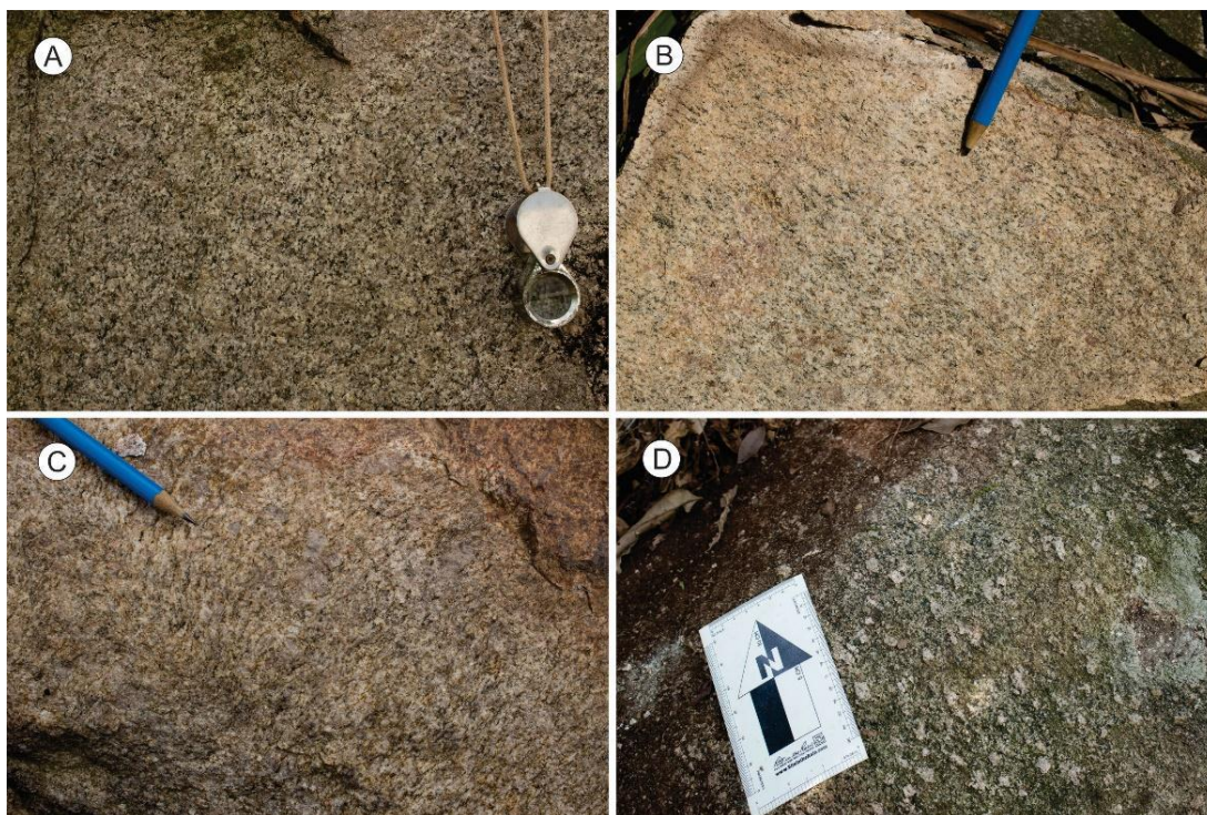
Figura 29: Orientação dos cristais de biotita/hornblenda devido a fluxos magmáticos em diferentes localidades.
