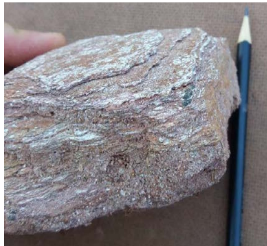
Figura 10: Amostra de Quartzo-muscovita-xisto intemperizada. Foto AP3-6-52.
