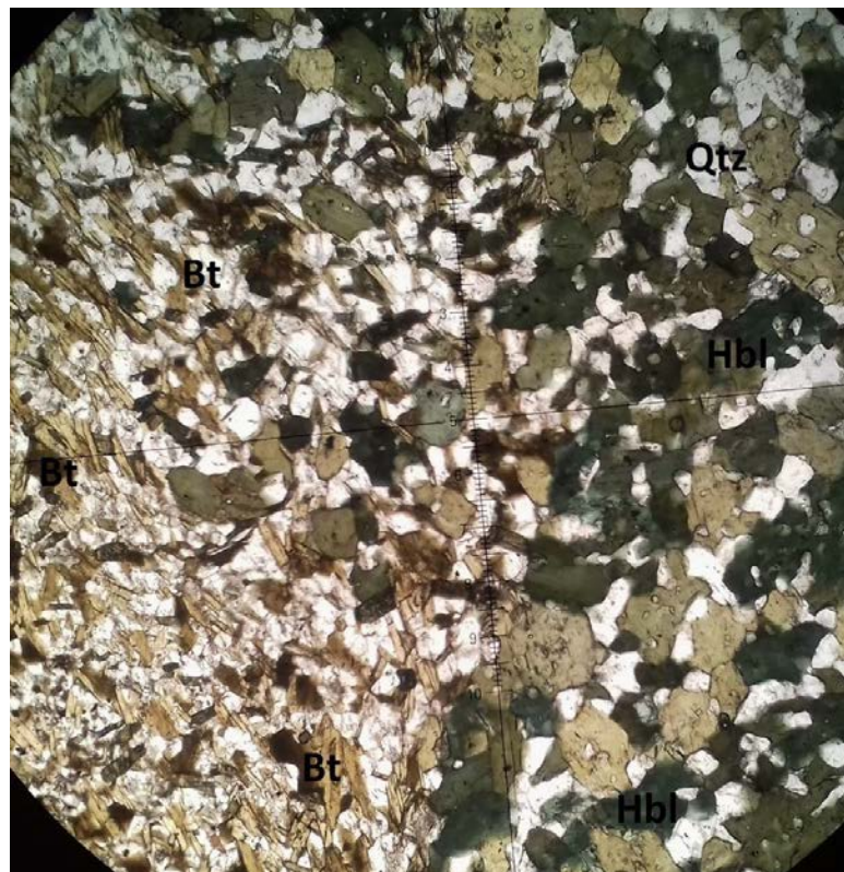
Figura 17 - Hornblenda e Quatzo na lâmina AP3-2-10. Aumento de 5x.
