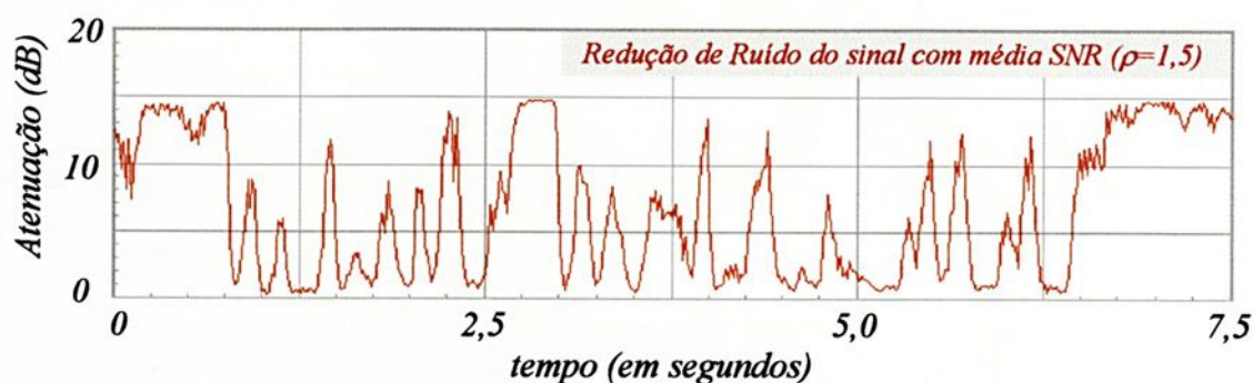
Figura V.28 – Redução de Ruído obtida após a filtragem do sinal de média SNR ( \rho=1,5 )
