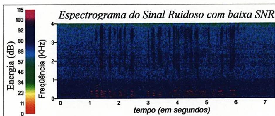
Figura V.33 – Espectrograma do sinal de voz ruidoso com baixa SNR
