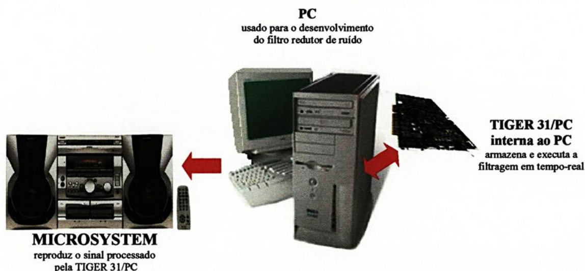
Figura IV.1 – Hardware usado no projeto do filtro redutor de ruído
