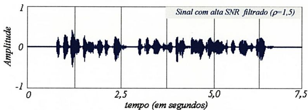
Figura V.9 – Sinal com alta SNR filtrado ( \rho=1,5 )
