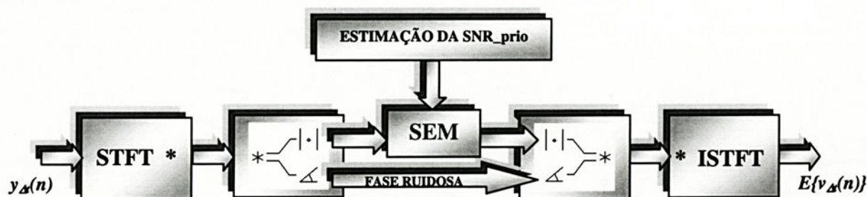
Figura II.4 – Redução de ruído usando a SEM
