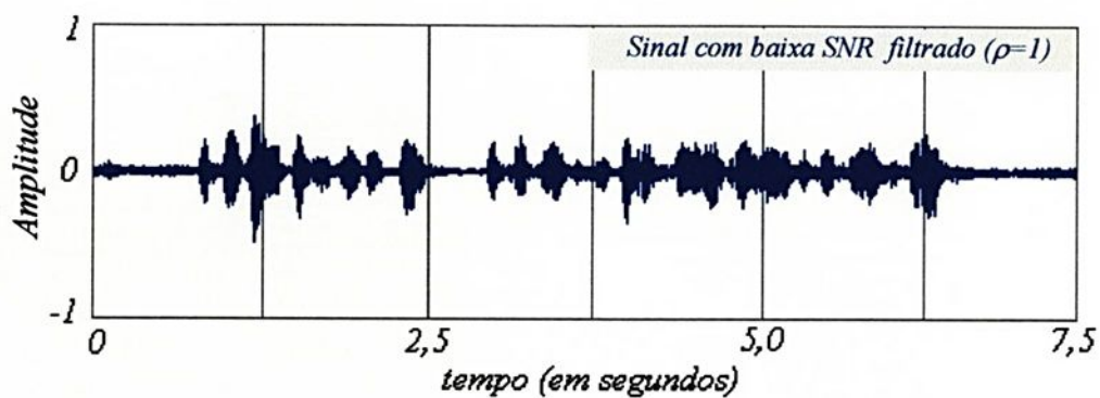
Figura V.8 – Sinal com baixa SNR filtrado ( \rho=1 )
