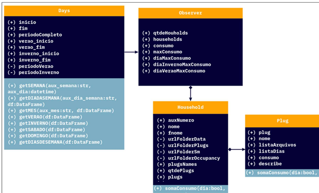
Figura 6. Diagrama de classe do algoritmo desenvolvido
