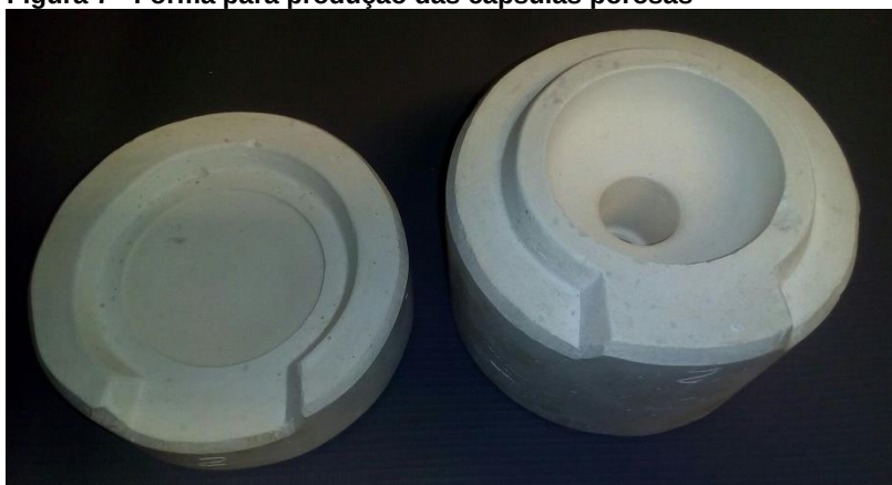
Figura 7 - Forma para produção das cápsulas porosas
