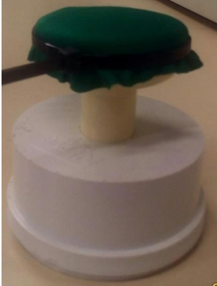
Figura 15 - Cápsula ATES com proteção montada na base de PVC
