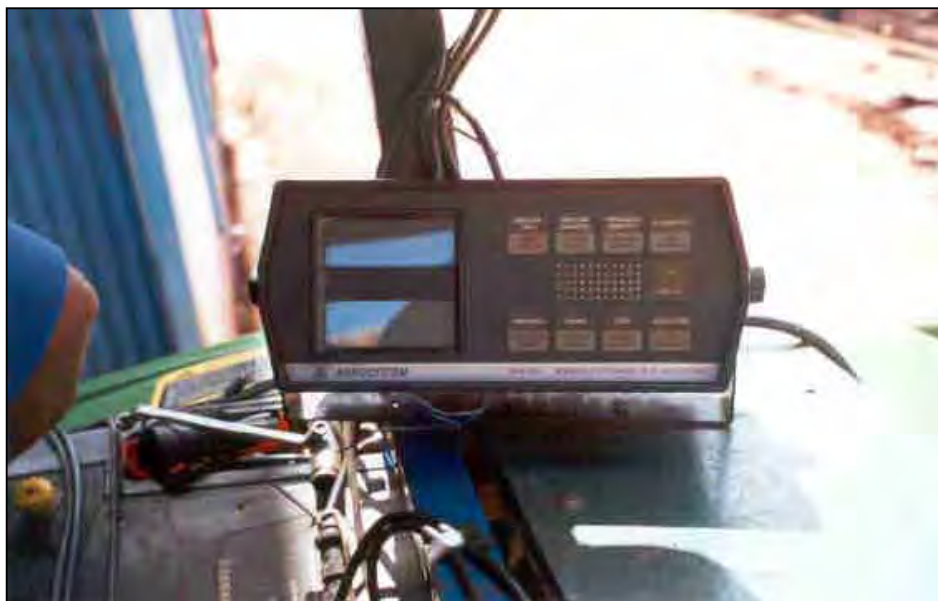
Figura 16. Vista parcial do monitor eletrônico de semeadoras montado no trator utilizado para instalação do experimento a campo.
