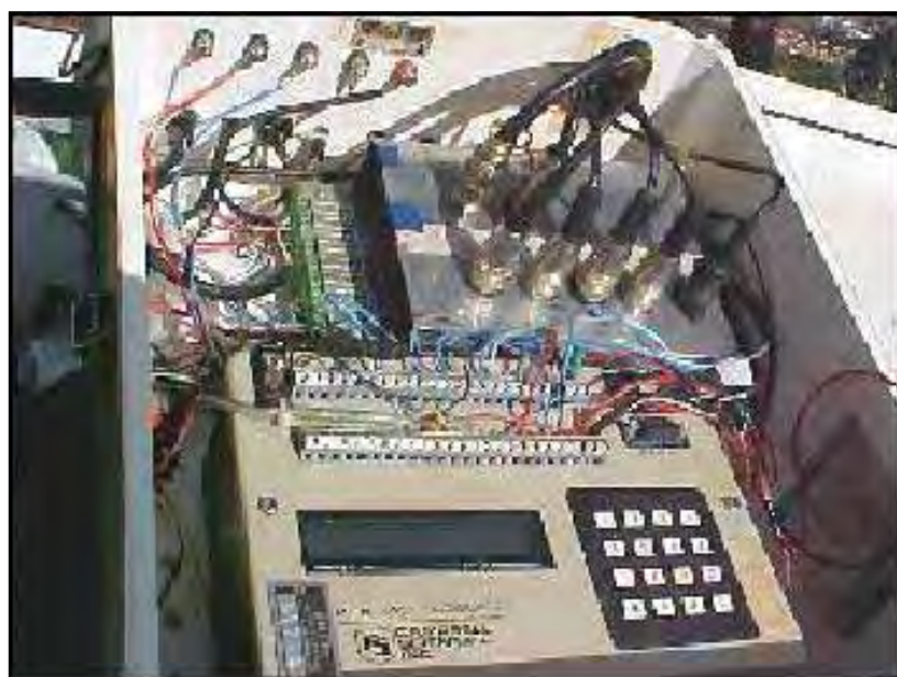
Figura 14. Vista parcial do Microllogger 21X utilizado para aquisição dos dados coletados.
