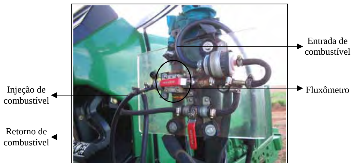
Figura 15. Vista parcial do fluxômetro utilizado para determinação do consumo de combustível.
