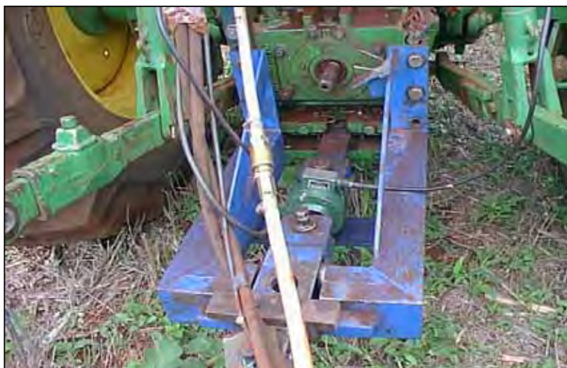
Figura 13. Vista parcial do suporte (azul) e da célula de carga utilizada para determinação da força de tração.
