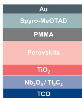
Figura 38: Arquitetura das células investigadas neste estudo. A concentração de Mxene foi variada e a amostra controle não possui incorporação de Mxene.
