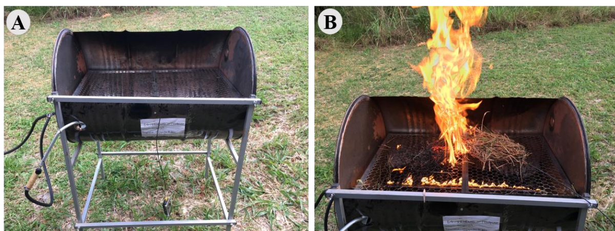
Figura 3: A) Visão geral do equipamento para medição dos atributos de inflamabilidade baseado em Jaureguiberry et al. 2011 . O equipamento consiste de um barril com dimensões aproximadas de 85 x 60 cm, cortado ao meio e posicionado horizontalmente sobre quatro pernas de metal. As amostras são arranjadas na grelha de forma horizontal para serem aquecidas, através dos queimadores inseridos no fundo do barril. B) Equipamento em funcionamento.
