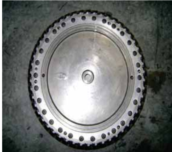
Figura 18: Fresa utilizada na máquina que realiza a usinagem do bloco.
