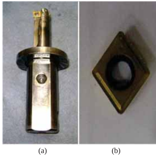
Figura 12: Ferramenta que realiza a usinagem do diâmetro do pino do pistão. (a) Barra que fica presa na máquina. (b) Pastilha de usinagem que realiza a essa operação de usinagem.
