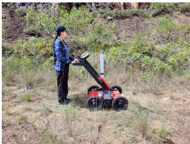
Figura 13: Equipamento GPR utilizado na investigação da subsuperfície.
