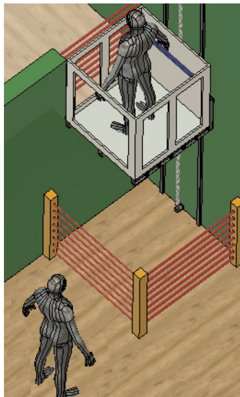
Figura 9 - Área útil monitorada pela cortina de luz.
