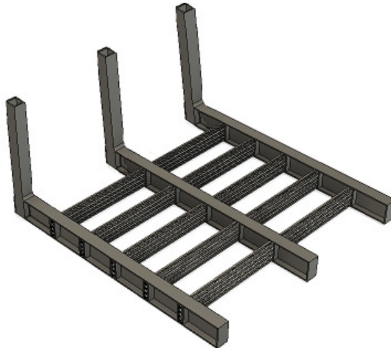
Figura 38 - Junção das Barras transversais e longitudinais da plataforma.
