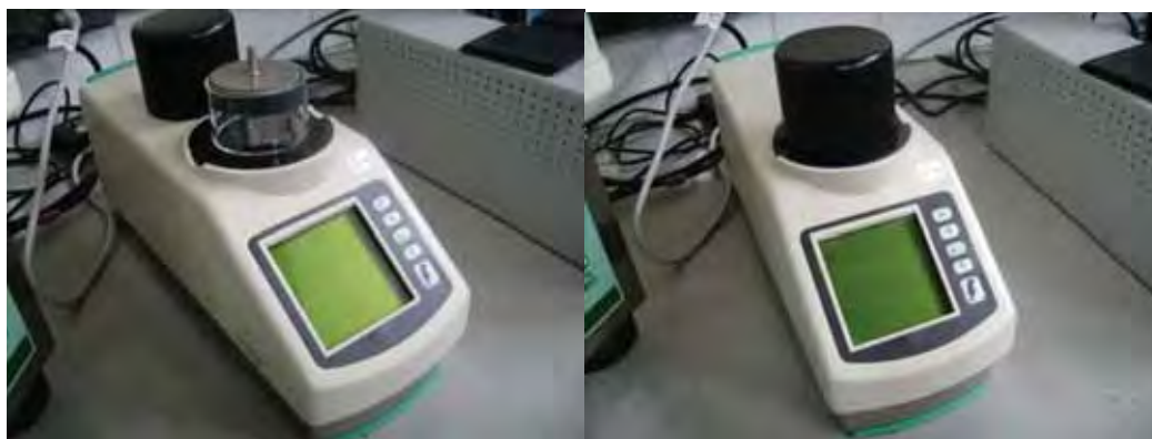
Figura 17. Espectrofotômetro ColorFlex, aparato de vidro com tampa e copo plástico.
