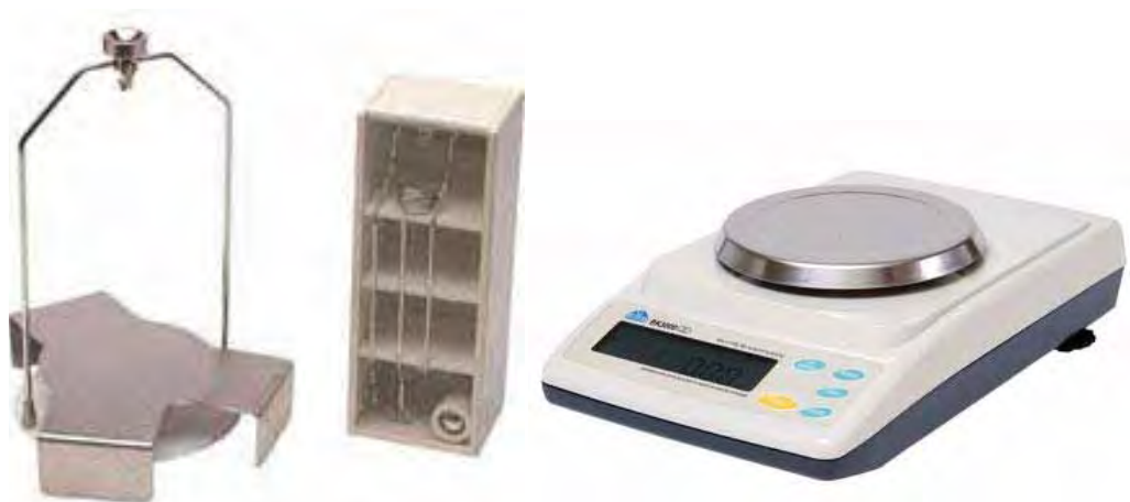
Figura 18. Kit Gehaka para determinação de densidade em balança semi-analítica.
