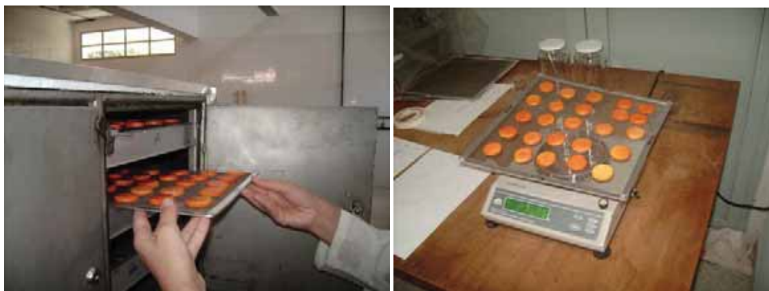
Figura 15. Disposição das amostras em bandejas dentro do secador convectivo e pesagem.
