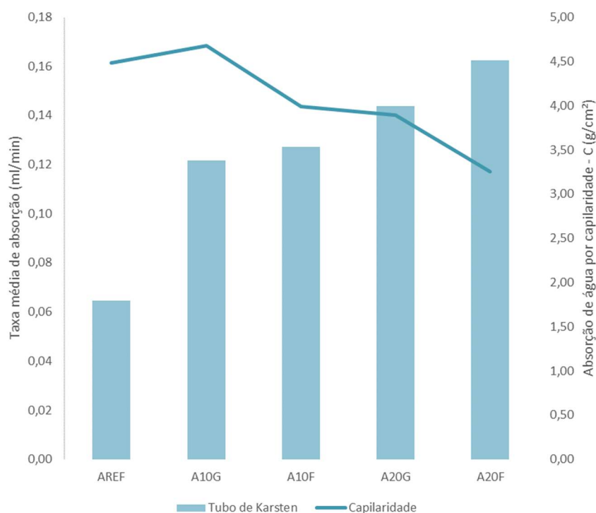
Figura 73. Comparação dos resultados da taxa de absorção por tubos de Karsten e absorção por capilaridade.
