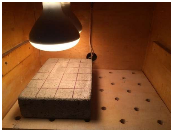
Figura 16. Aparato de ativação com duas lâmpadas infravermelho.
