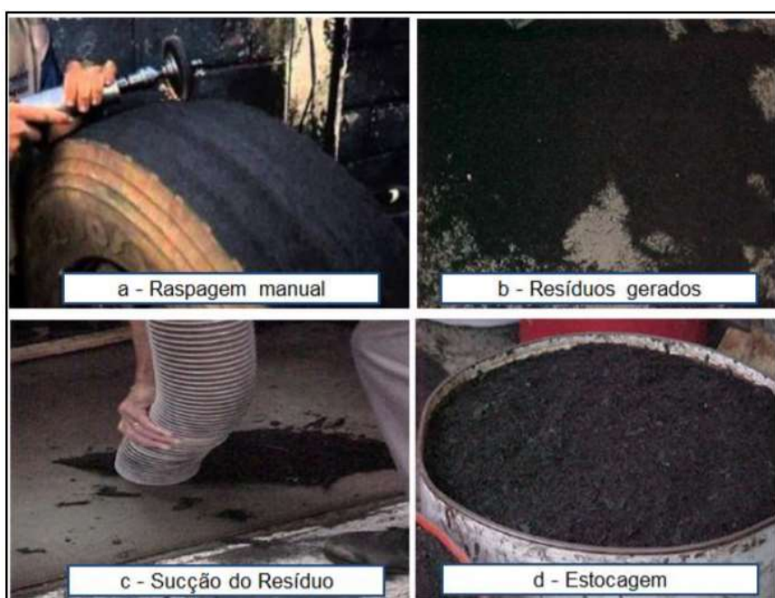
Figura 6. Processo de recauchutagem que produz resíduo de borracha
