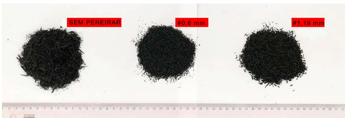
Figura 12. Amostra de borracha sem peneirar, granulometria #0,6 mm e #1,19 mm.
