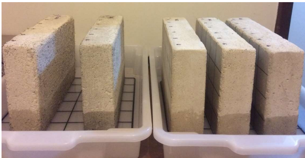
Figura 21. Procedimento do ensaio de absorção por capilaridade.
