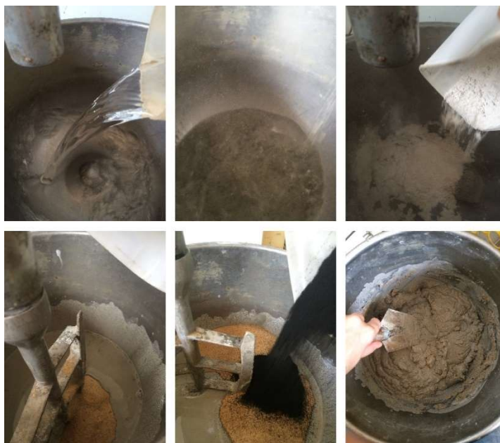
Figura 14. Processo de mistura dos materiais para confecção das argamassas mistas.
