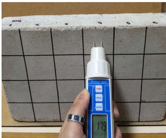
Figura 25. Aferição de umidade do corpo de prova com a malha auxiliar.
