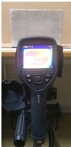
Figura 24. Execução do ensaio de termográfico.
