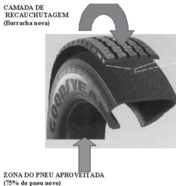
Figura 5. Pneu preparado para receber a nova camada de borracha.
