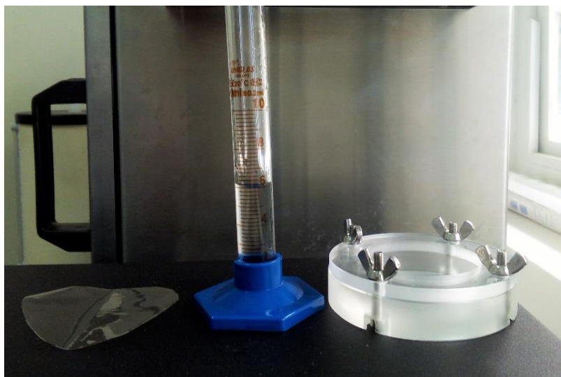
Figura 8 – Filme cortado e célula utilizada para realizar as medidas de PVA
