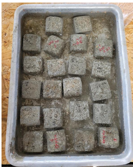
Figura 9 – Imersão dos corpos de prova em água
