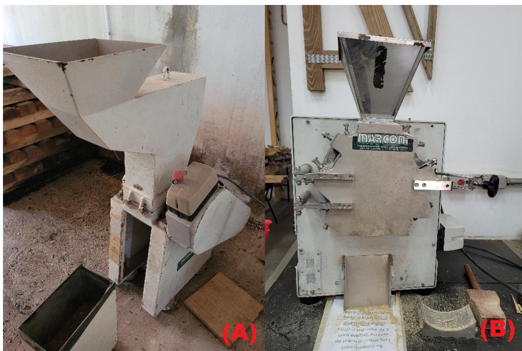
Figura 1 – Processamento das partículas de madeira, sendo (A) picador de tambor e (B) moinho tipo Wiley
