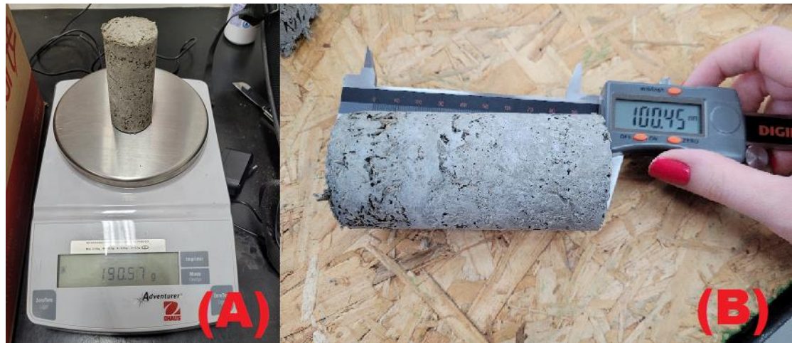
Figura 7 – Realização do ensaio de densidade aparente, sendo (A) pesagem em balança semianalítica e (B) medição com paquímetro digital
