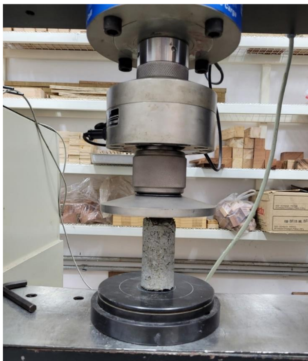
Figura 11 – Realização do ensaio de resistência à compressão
