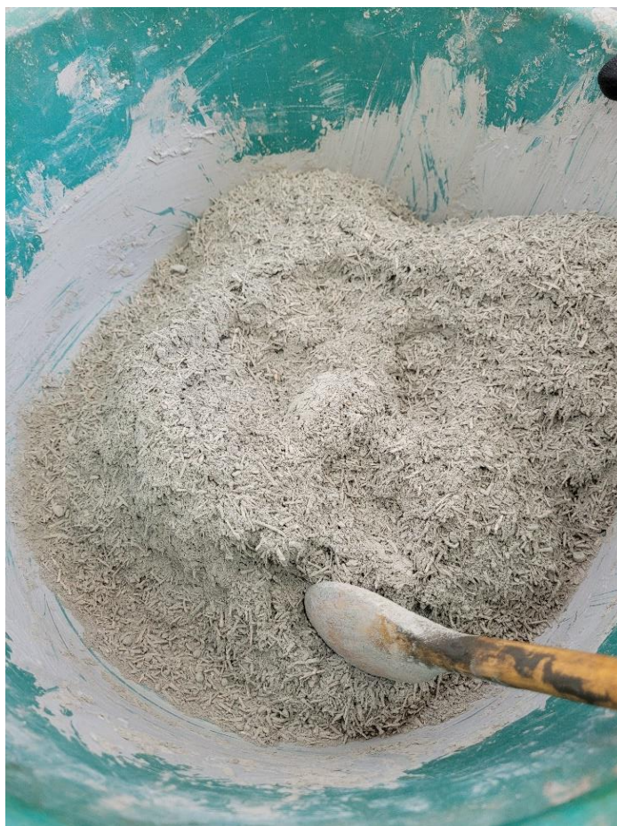
Figura 3 – Cimento, cinzas e madeira misturados antes da adição de água para produção do compósito
