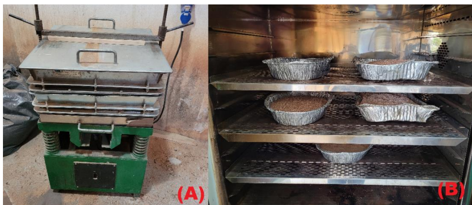
Figura 2 – Preparação das partículas de madeira, sendo (A) jogo de peneiras vibratórias e (B) secagem em estufa
