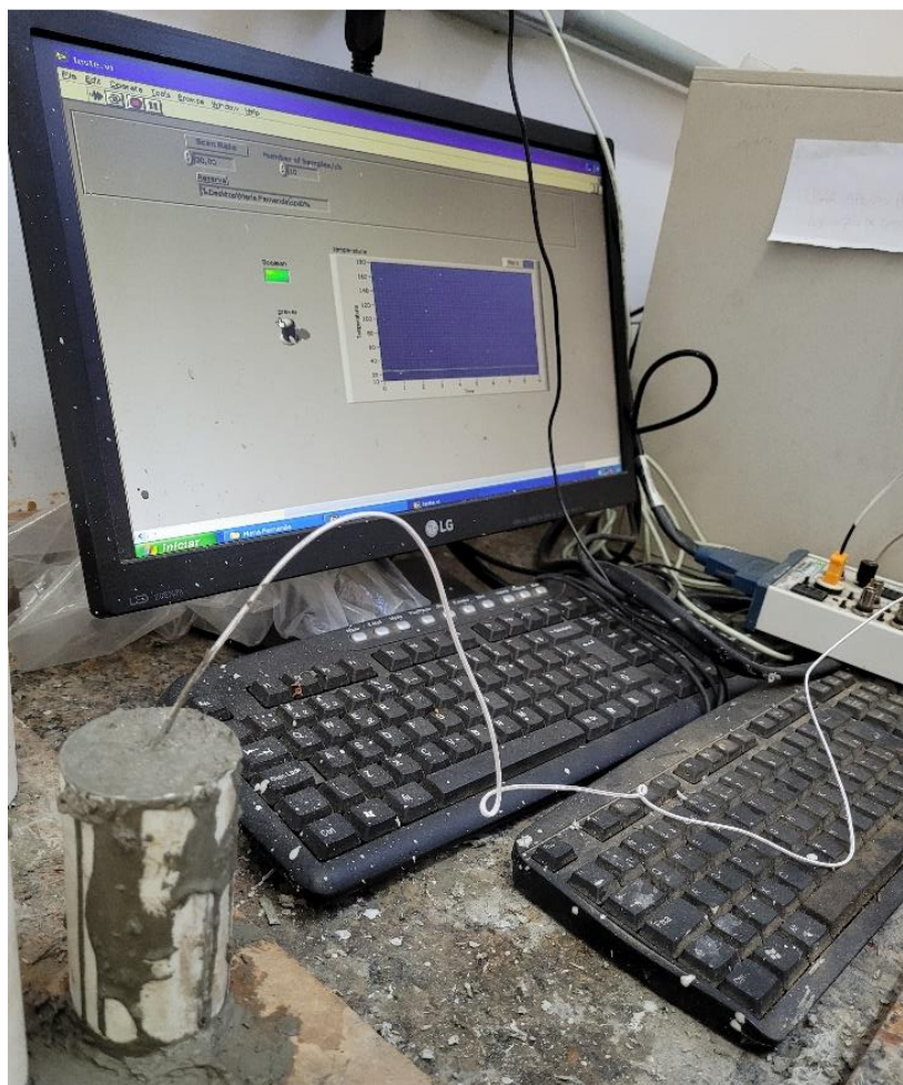
Figura 6 – Aquisição dos valores de temperatura e tempo dos compósitos.
