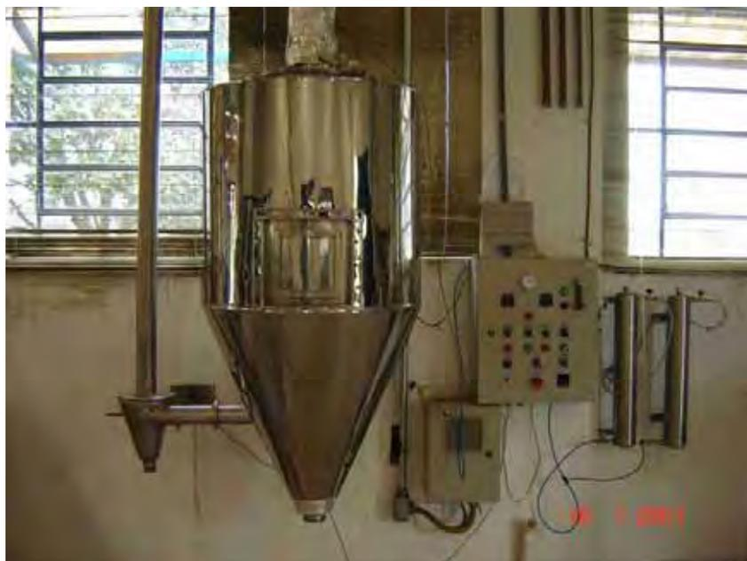
**Figura 13.** Secador tipo “spray dryer” utilizado na secagem das maltodextrinas.
