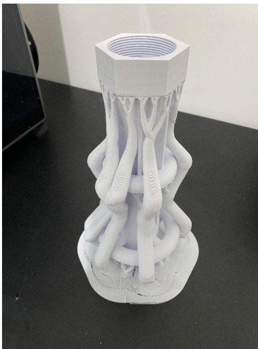
Figura 63 – Tubo de Venturi imediatamente após ser removido da impressora 3D com os suportes em árvore
