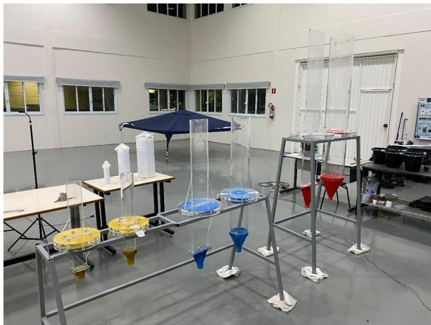
Figura 19 - Leitos fluidizados tridimensionais e bidimensionais utilizados para os experimentos de mudança de escala
