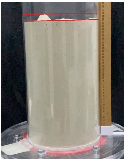
Figura 115- Captura de tela do vídeo de fluidização para avaliar a expansão do leito - Experimento 8 Réplica 2
