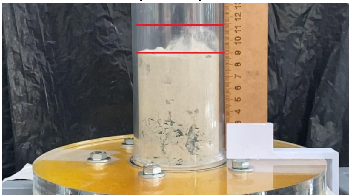
Figura 103- Captura de tela do vídeo de fluidização para avaliar a expansão do leito - Experimento 2 Réplica 2
