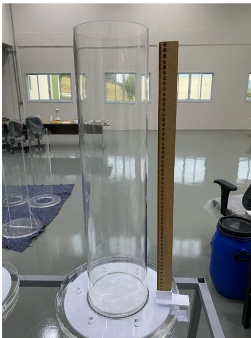
Figura 12 - Régua com suporte utilizada para medir expansão do leito
