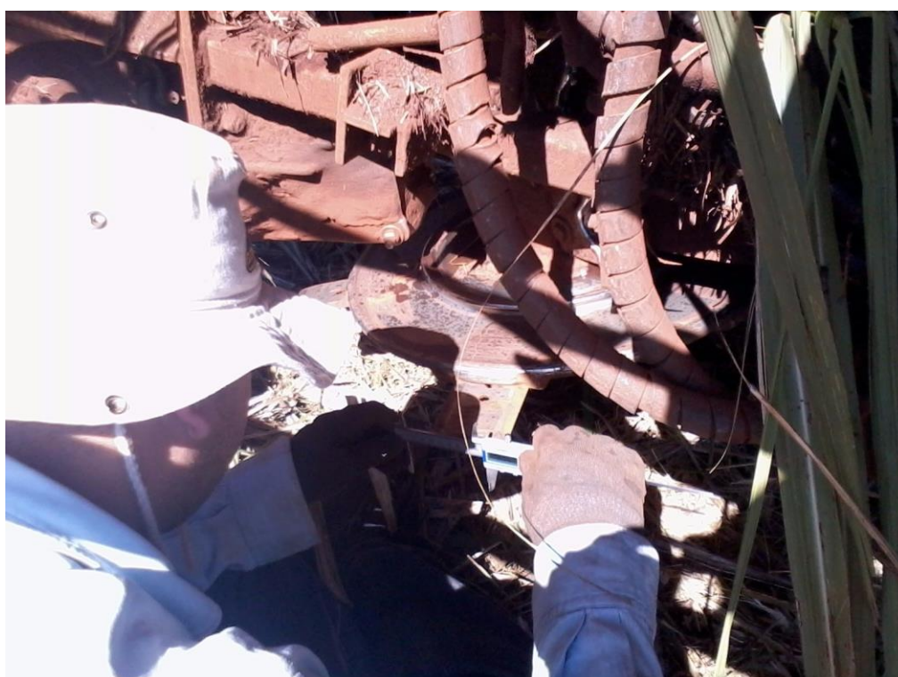
Figura 4. Medida do desgaste das facas do corte de base da colhedora de cana-de-açúcar.
