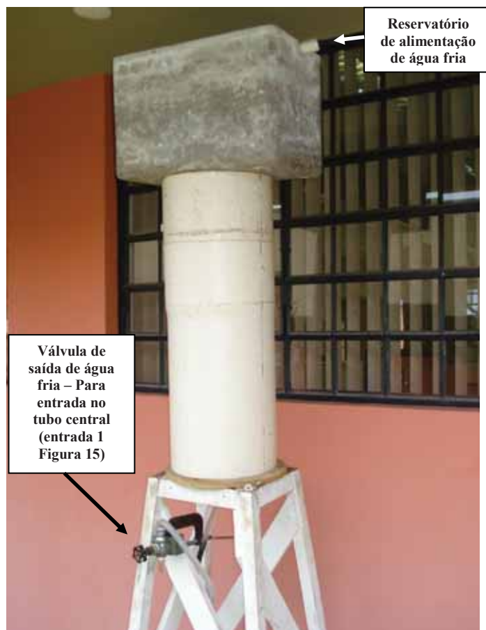
Foto 4: Reservatório de água fria para manutenção da pressão constante
