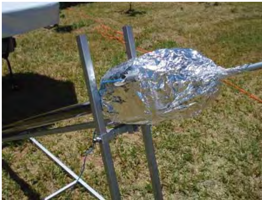
Foto 7: Isolamento térmico do conector de passagem de água
