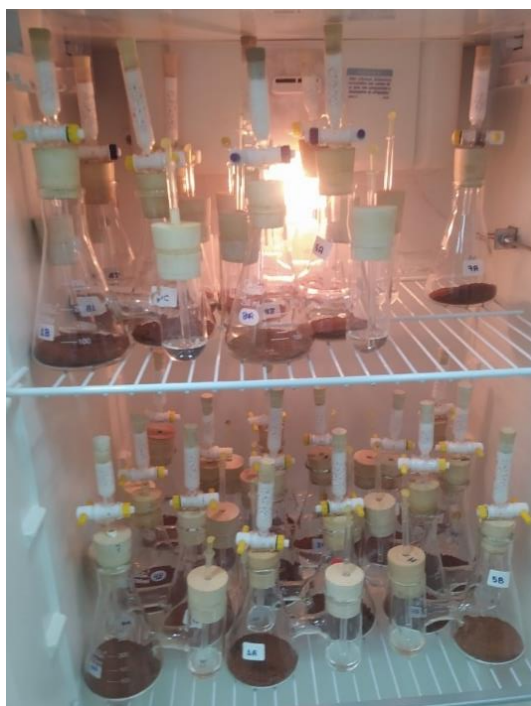
Figura 11 – Os respirômetros ficaram armazenados em uma incubadora BOD, a 28°C, durante as treze semanas de realização dos experimentos.
