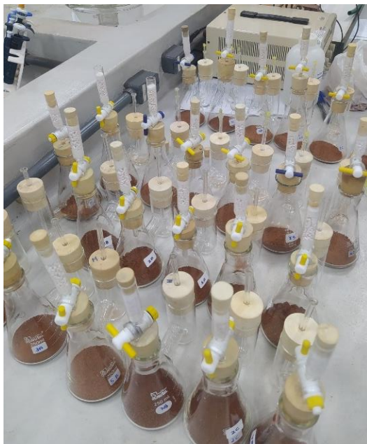
Figura 10 – Montagem experimentos (em triplicata) utilizando os respirômetros, a solução de KOH e o solo preparado conforme Quadro 1.
