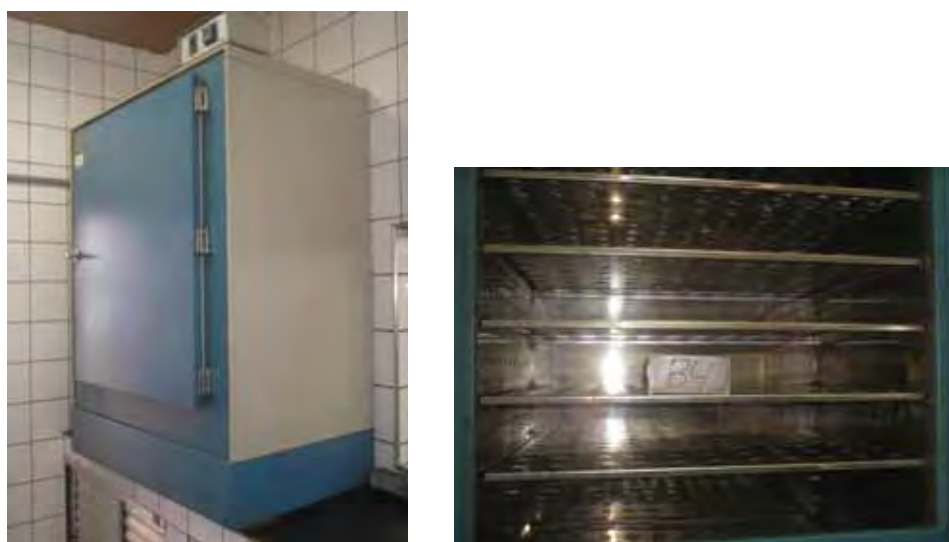
Figura 13 – Estufa, vista do equipamento (esquerda) e vista interna com cesto utilizado para conter amostra (direita).
