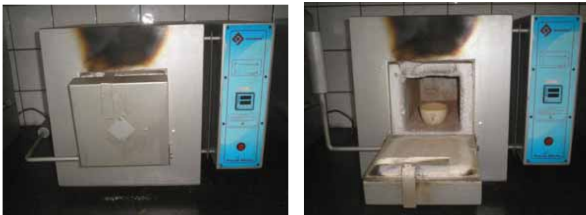
Figura 14 – Mufla com regulação de temperatura, vista do equipamento (esquerda) e vista interna com cadinho utilizado para conter amostra (direita).
