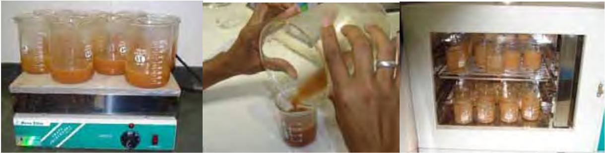
FIGURA 14. Determinação da concentração mássica pelo método gravimétrico.
