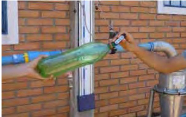
FIGURA 12. Determinação da temperatura no momento de coleta das suspensões.
