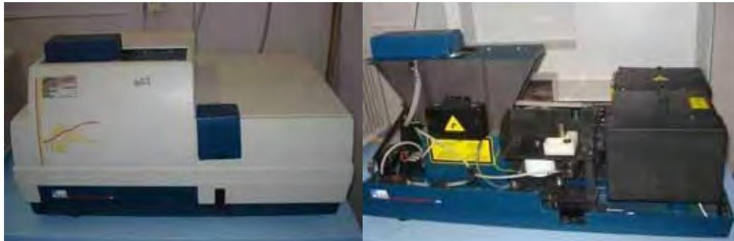
FIGURA 15. Analisador granulométrico, marca CILAS, Modelo 1180 LD.
