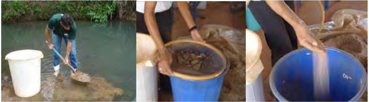
FIGURA 7. Coleta e preparo da areia recolhida em assoreamento no Rio Lanoso - Uberaba - MG.
