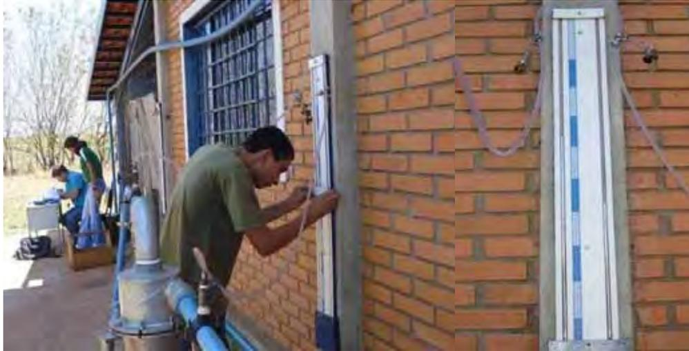
FIGURA 16. Momento de leitura das pressões nas correntes de alimentação e “overflow” e coluna de mercúrio em “U”.
