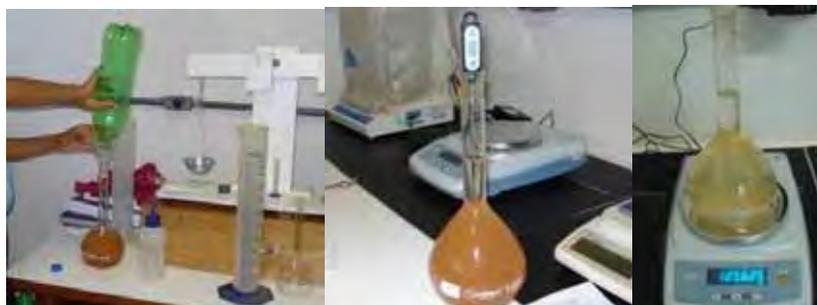
FIGURA 11. Determinação das densidades absolutas das suspensões aquosas com solo e areia.
