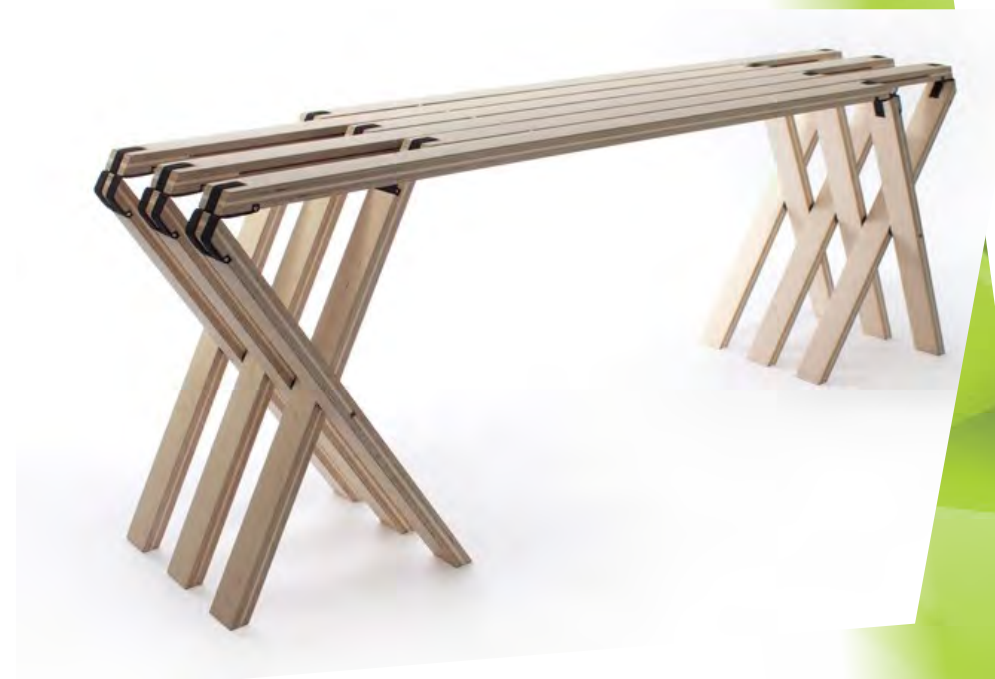
Figura 9 - 63 Degrees Bench by Severin Arnold, Bluemel Finn, and Angelina Barks - Banco dobrável que se fecha totalmente e numa estrutura com quase metade de sua extensão. Dobradiça feita a partir de fitas amarradas intercaladas entre das partes.
