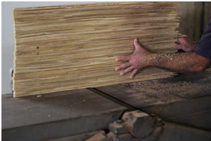
Figura 48 - Nivelamento das laterais da placa em desempenadeira
