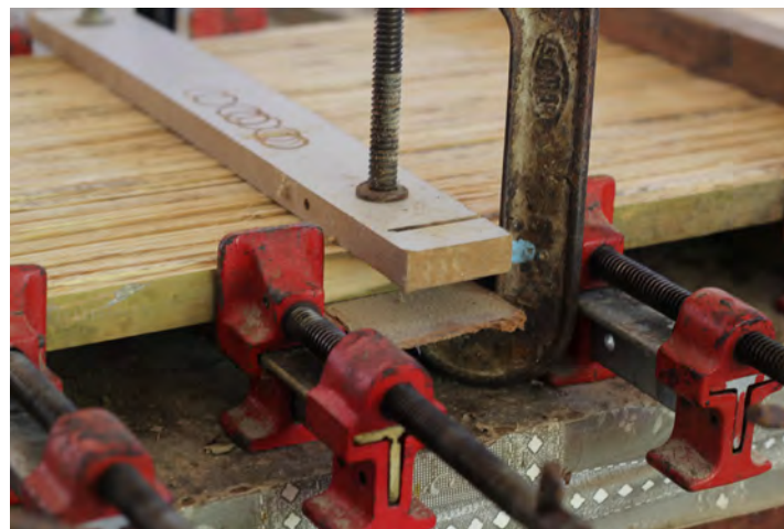
Figura 43- Colagem lateral e prensagem das ripas
