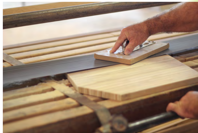
Figura 59 - Lixamento no sentido das fibras para acabamento
