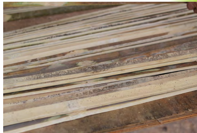
Figura 38 - Ripas de bambu ainda com casca, parenquima e nós
