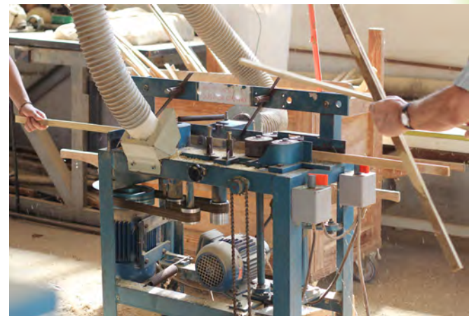
Figura 39- Processamento do bambu na super-taquara, retirada da casca e do nós
