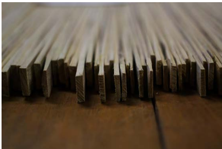
Figura 40 - Ripas de bambu já processadas, prontas para a colagem do BLCs
