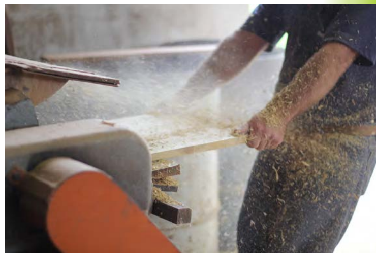
Figura 46 - Processamento em desengrossadeira
