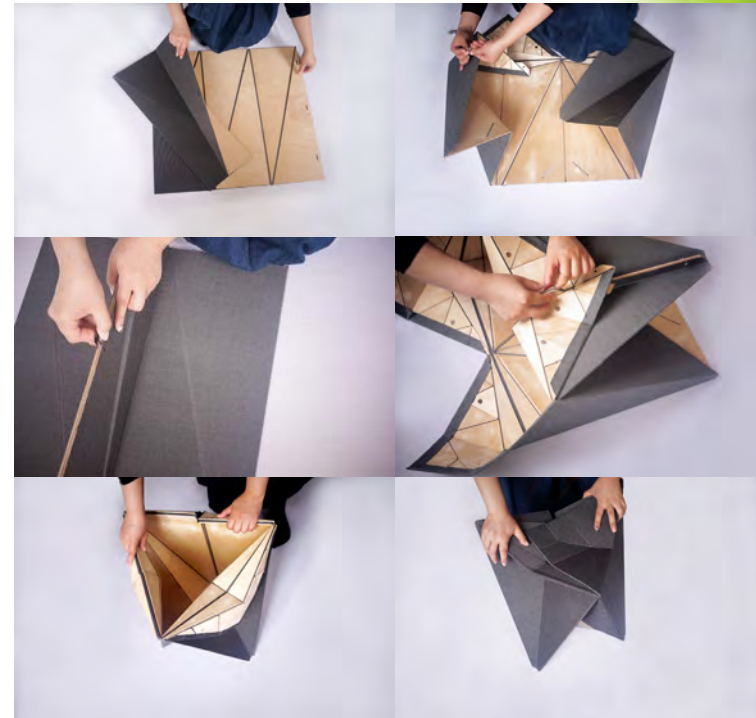
Figura 7 - Playtime Collection 2013 by Zhang & Thonsgaard - Móvel versátil: banquinho dobrável desmontável. Dobradiça feita a partir de tecido colado por fora.
