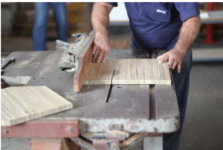
Figura 56 - Corte dos retangulos na serra circular de mesa
