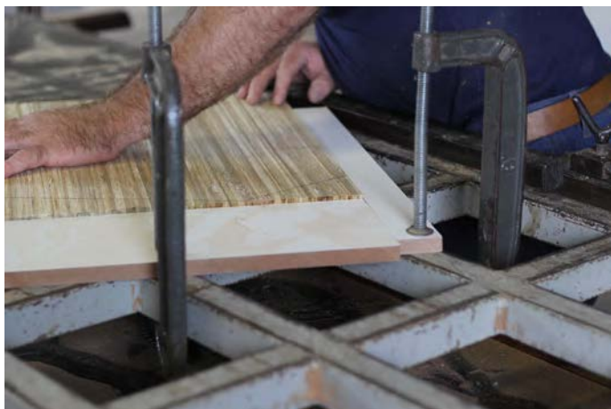
Figura 53 - Medição dos ângulos e travamento com gabaritos
