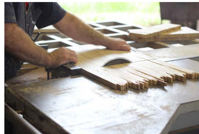
Figura 51 - Corte em esquadrejadeira nas medidas finais das placas do móvel (430 x 370mm)
