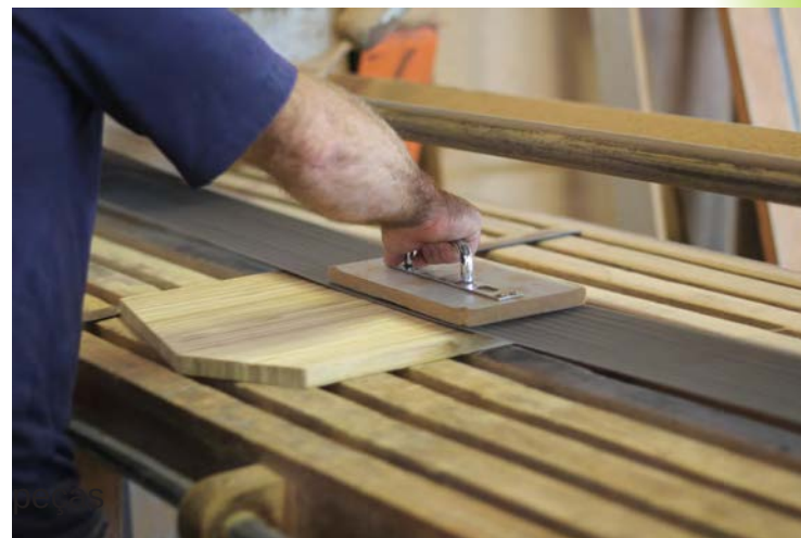
Figura 58 - Lixamento no sentido contrário das fibras, para remoção de relevos indesejados
