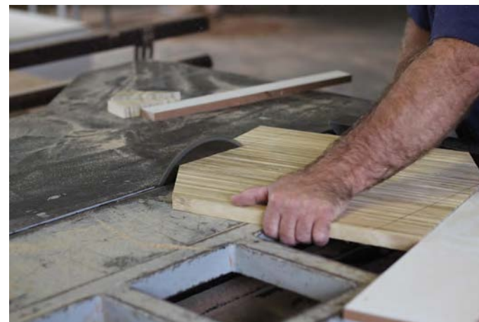
Figura 54 - Corte em ângulo, com gabaritos travados
