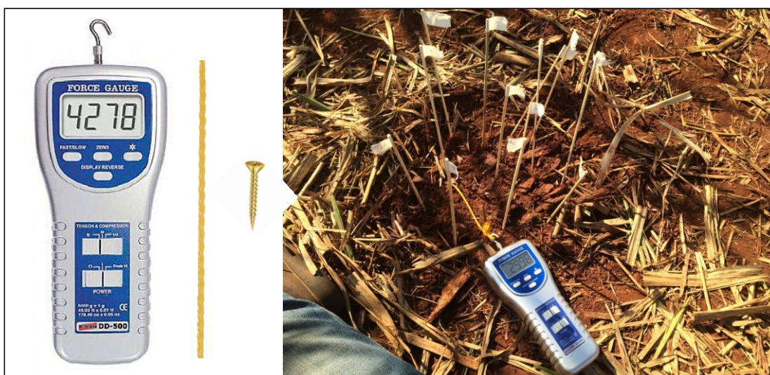
Figura 3. Dinamômetro Digital Portátil Instrutherm modelo DD-500 e os acessórios (gancho, corda trançada de polipropileno de 1,5 mm e um parafuso 6,0 x 25 mm).
