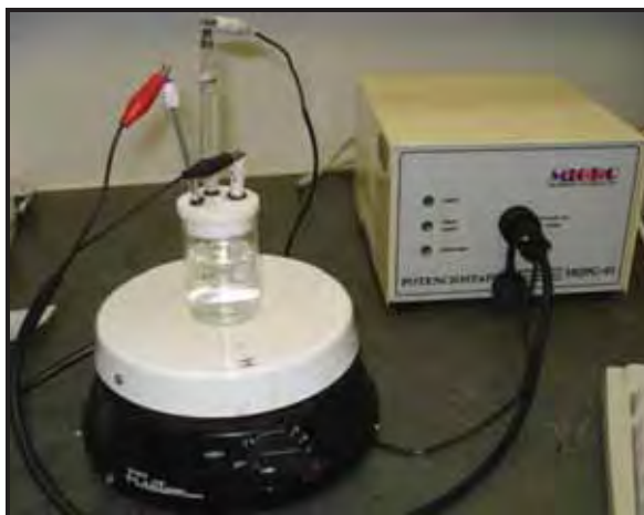
FIGURA 14 – Sistema eletroquímico utilizado nas medições.
