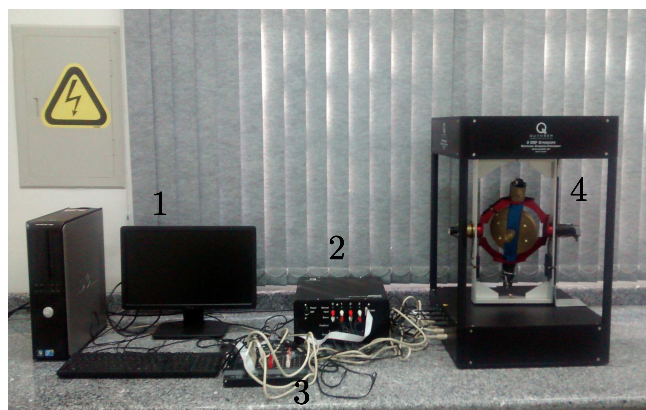
Figura 5 – Bancada experimental: (1) é o computador, (2) é o amplificador, (3) é a placa de aquisição e (4) é o giroscópio.
