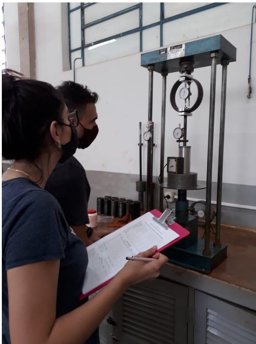
Figura 13 – Leitura da penetração no ensaio mini-CBR
