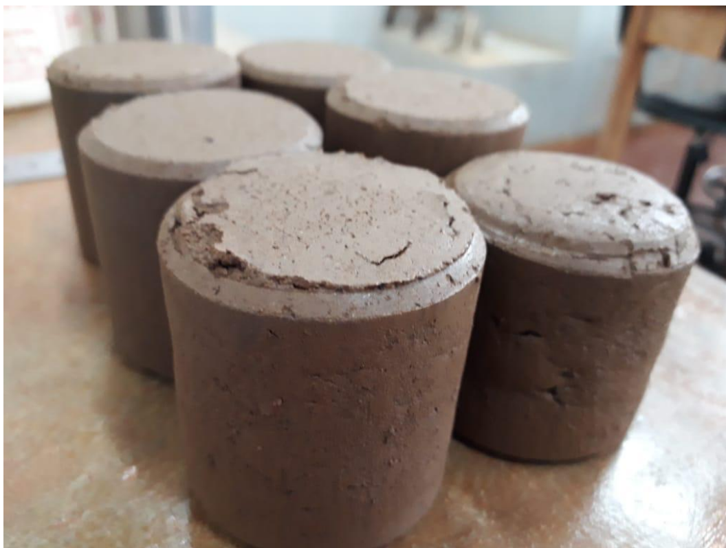
Figura 11 – Corpos-de-prova após compactação no mini-proctor
