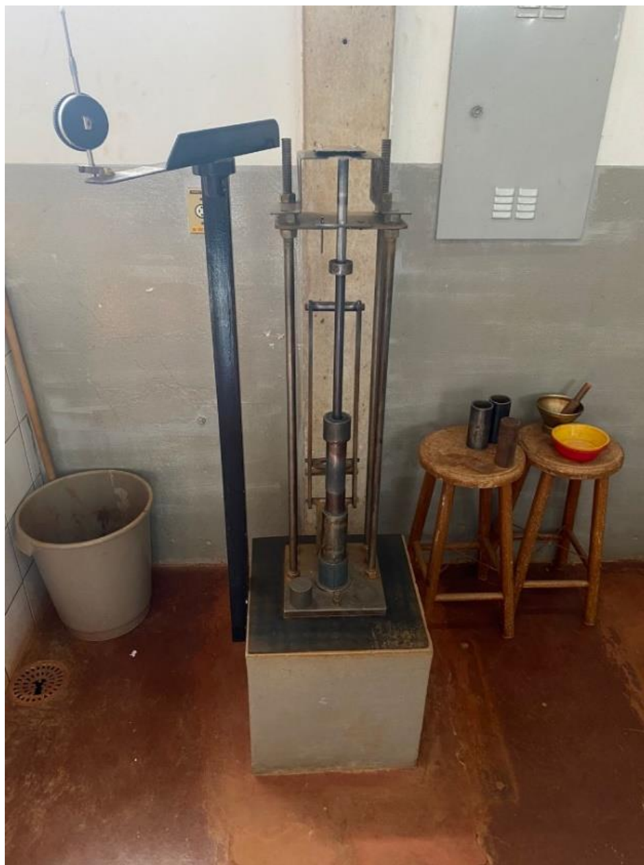
Figura 10 – Equipamento para compactação do ensaio mini-proctor
