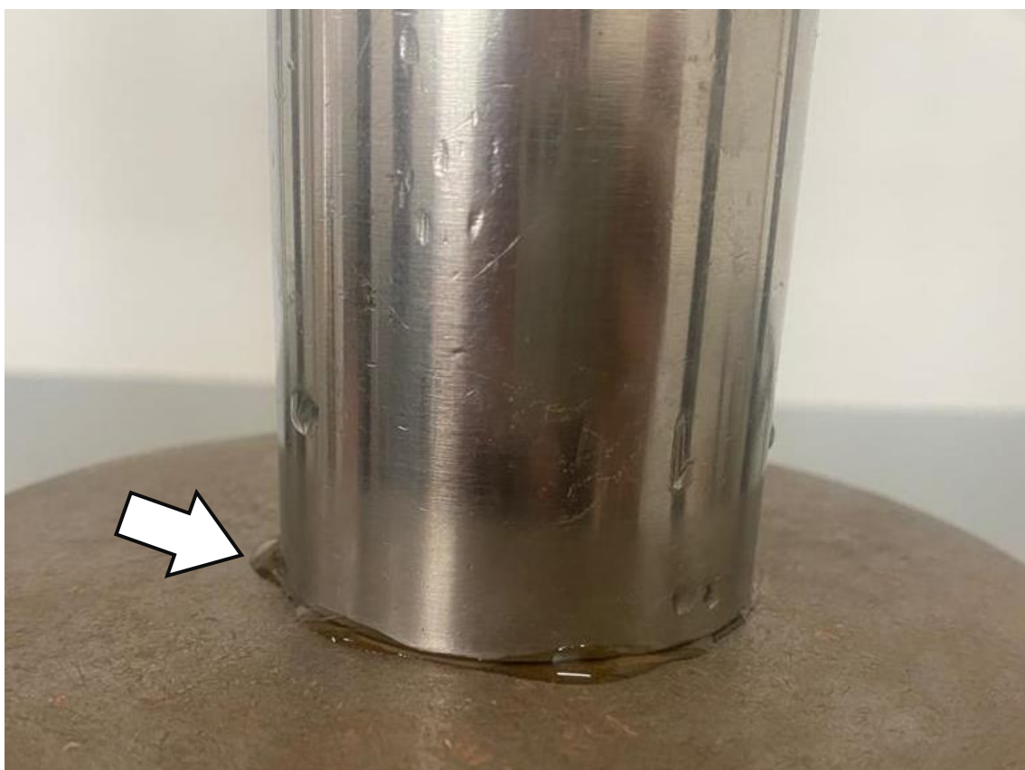
Figura 20 – Corpo-de-prova exudando água durante o ensaio
