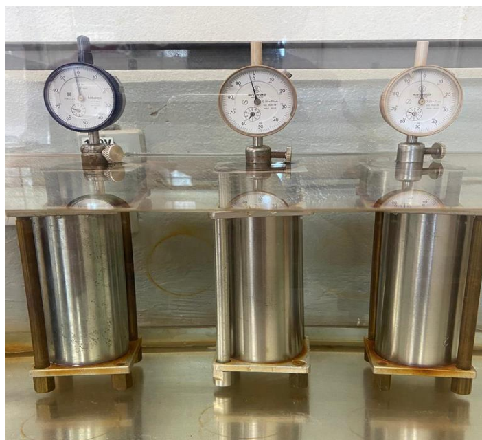
Figura 14 – Corpos-de-prova em imersão para mini-CBR
