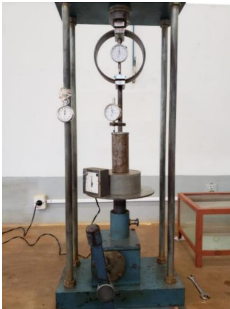
Figura 12 - Prensa de CBR para ensaio de resistência a penetração
