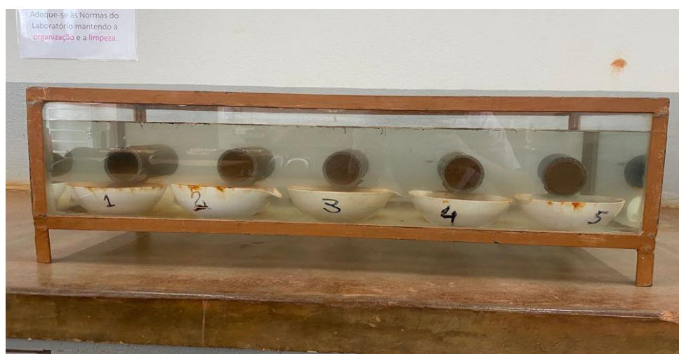
Figura 6 – Corpos-de-prova em imersão
