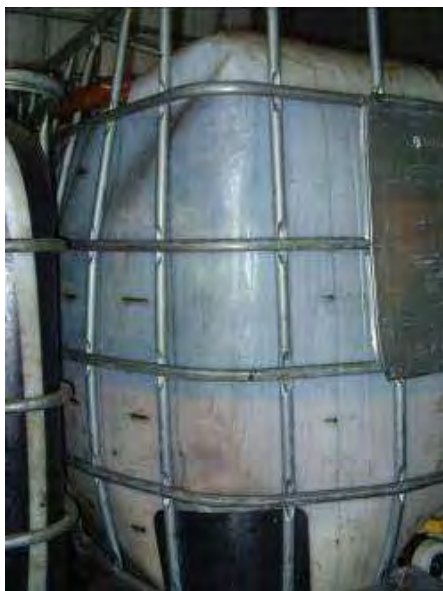
Foto 30 - IBC em processo de decantação. O óleo (fase mais escura) fica suspenso enquanto a gordura (mais clara) permanece no fundo. Crédito: R A Pafunda
