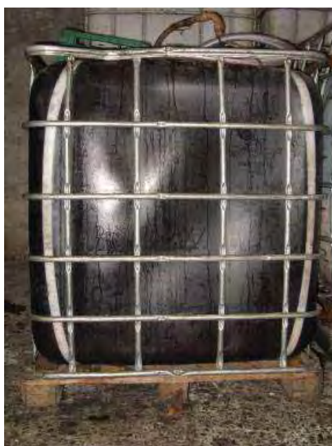
Foto 31 - IBC preto. As barras de ferro laterais o protegem contra choques. Crédito: R A Pafunda
