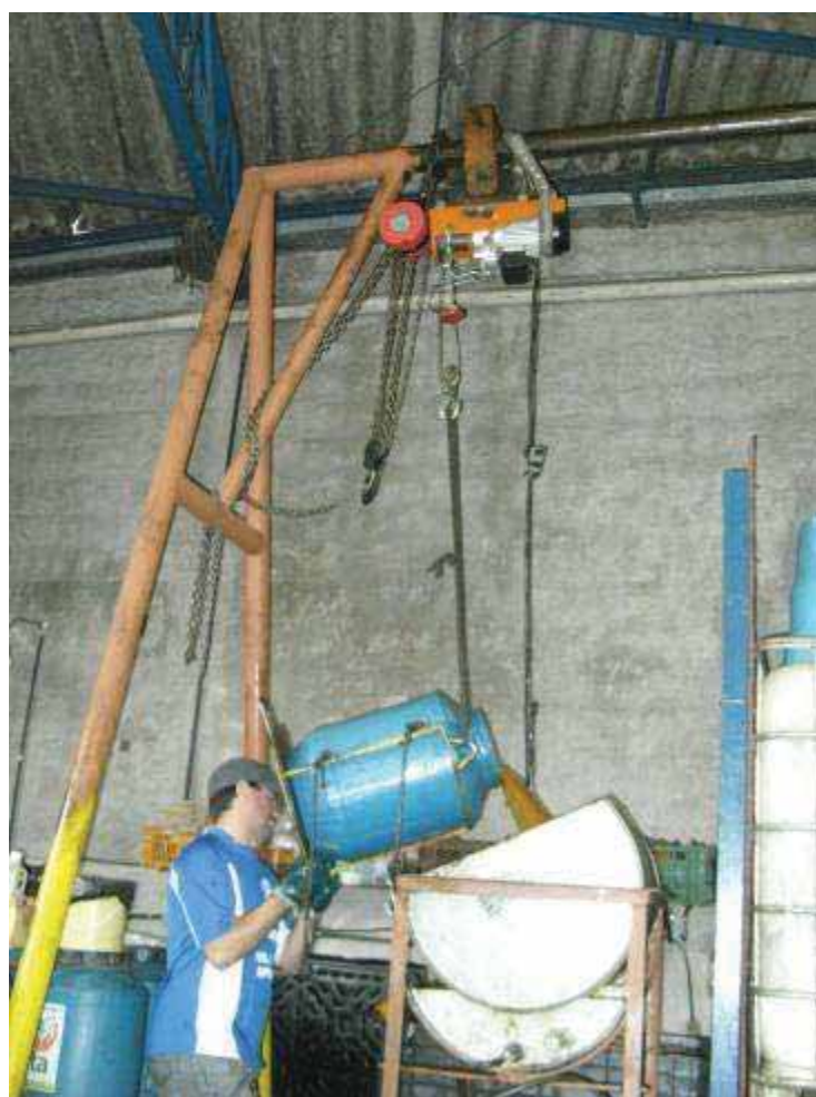
Foto 21 - Etapa de aquecimento do óleo. A bombona é elevada por uma talha. Crédito: R A Pafunda
