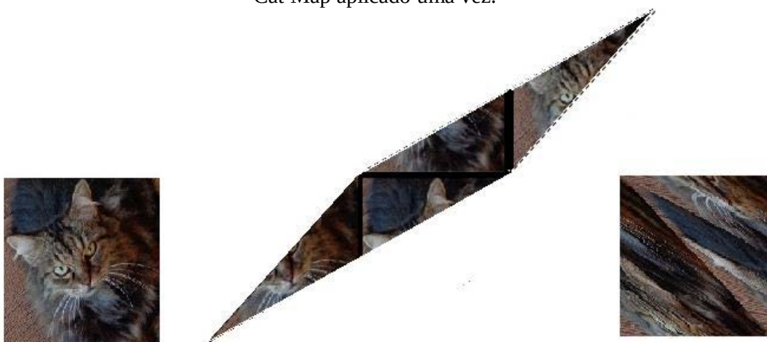
Figura 21 - Representação esquemática da resultante do segundo passo do algoritmo Arnold's Cat Map aplicado uma vez.
