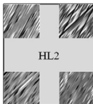
Figura 57 - Inserção aleatória dos blocos nos quatro cantos da sub-banda HL_2 .
