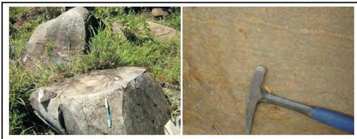
**Foto 15 Afloramento MC- 164 de gnaisses exibindo forte bandamento composicional.**
