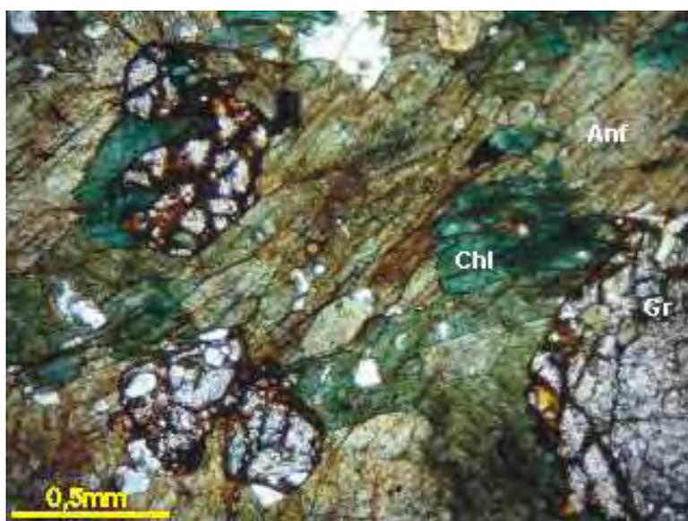
**Fotomicrografia 19 Lâmina MC- 86 apresentando cloritas junto com os anfibólio e granadas.**
