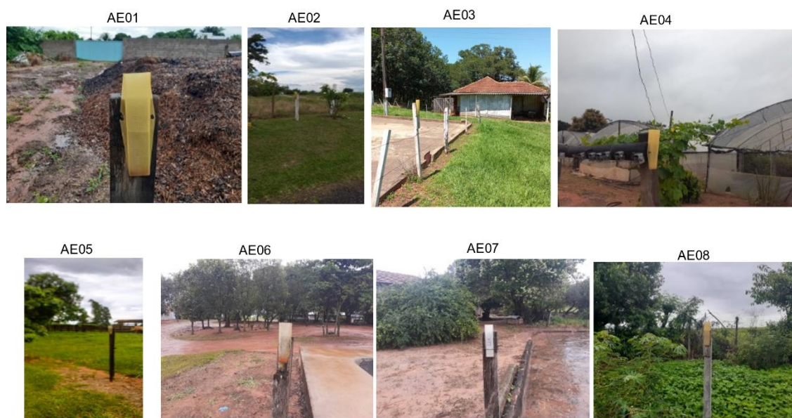
Figura 18. Imagens dos pluviômetros instalados em cada propriedade que participou do estudo.
