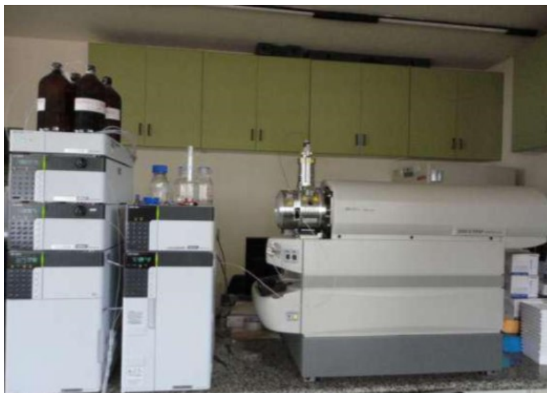
Figura 4. Cromatógrafo Líquido (Proeminence UFLC) acoplado ao espectrômetro de massas (3200 Q TRAP) LC-MS/MS.
