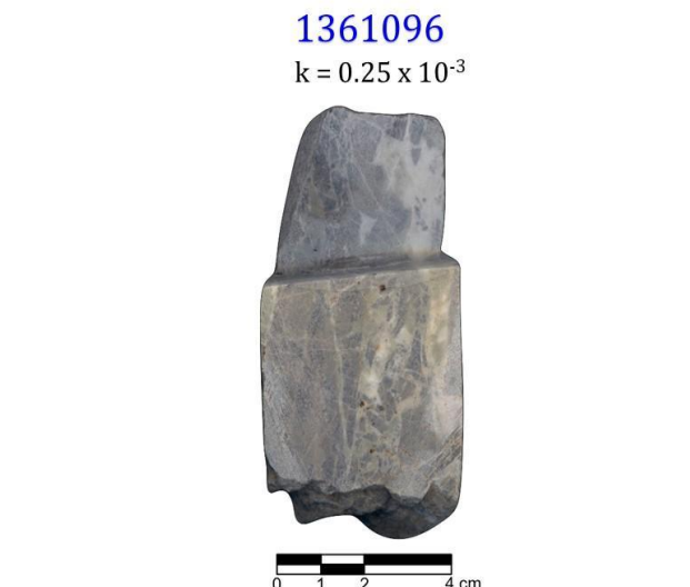
Figura 18: Amostra do litotipo metamáfico 1361096 da base do furo. Profundidade: 1361096/504,00 m. O valor de K está em S.I.
