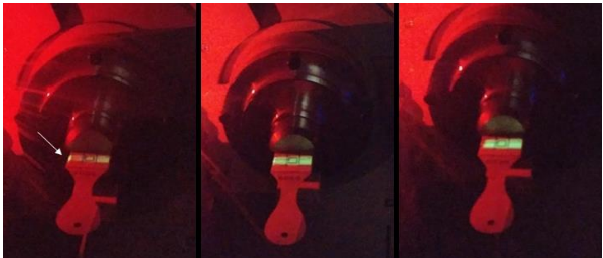
Figura 10: Teste de fluorescência para diferentes ângulos fixo. Da esquerda para direita: 1,5^\circ ; 2,5^\circ e 3,5^\circ .
