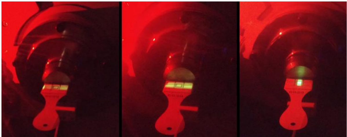
Figura 9: Teste de fluorescência. Da esquerda para direita: ângulos menores que 5°; entre 5° e 30°; maiores que 30°.
