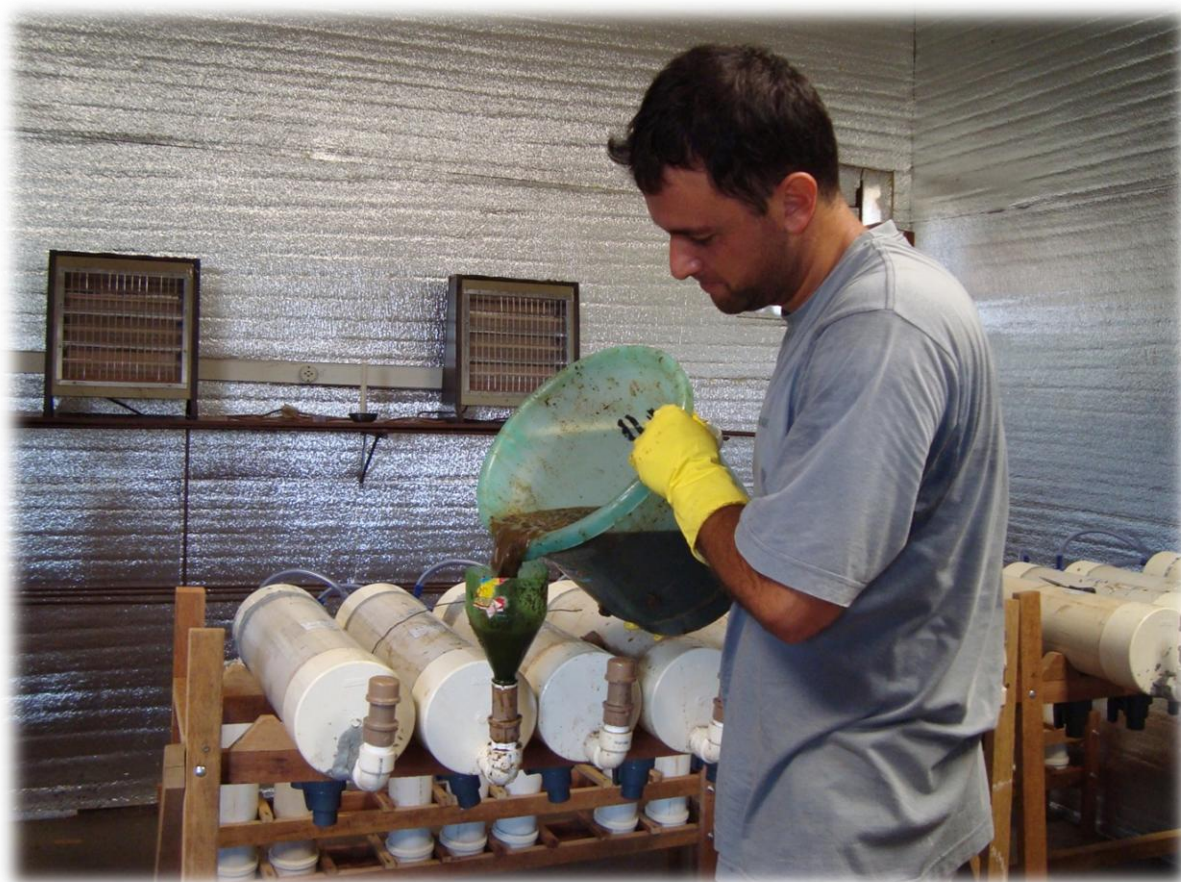
Figura 3: Abastecimento do biodigestor na sala de aquecimento após quantidade de sólidos e pH corretos para o tratamento.
