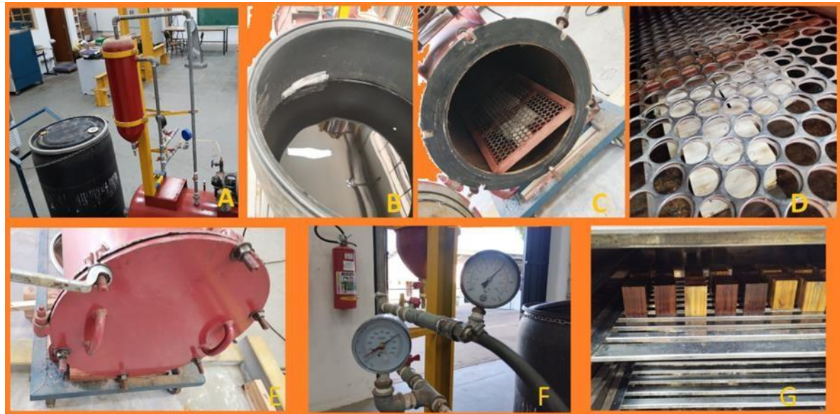
Figura 27 – Ensaio de delaminação: circuito (A), reservatório (B), câmara (C), grade (D), tampa câmara (E), manômetro (F), secagem amostras (G).
