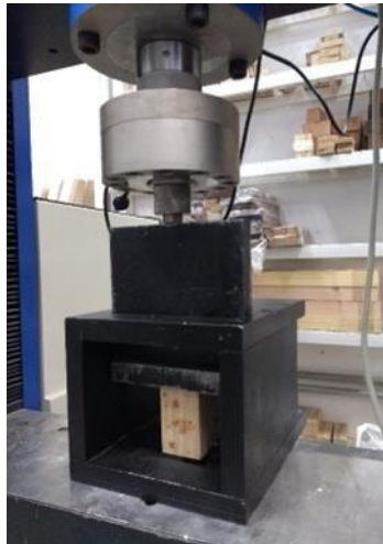
Figura 29 – Dispositivo de aplicação de força de cisalhamento na linha de cola.
