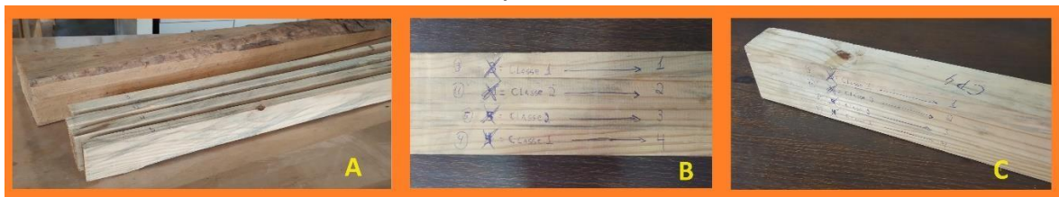
Figura 22 – (A) lamelas identificadas, (B) edição da identificação, (C) viga com lamelas posicionadas.
