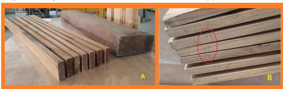
Figura 17 – Peça termorretificada método PlatoWood e lamelas, (B) lamelas identificadas.
