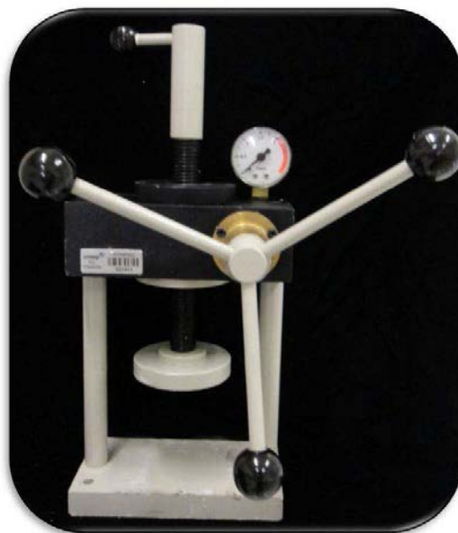
Figura 11: Prensa hidráulica (Midas, São Paulo, SP, Brasil), usada para prensagem da resina acrílica de ativação química.
