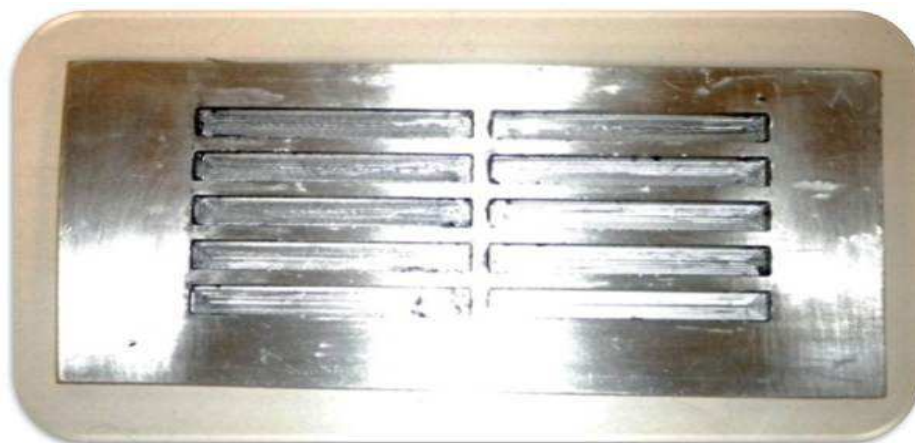
Figura 5: Matriz metálica sem tampa, contendo dez aberturas com dimensões 75 X 10 X 6mm, utilizada para confecção da porção de silicone e adesão à barra de resina acrílica.
