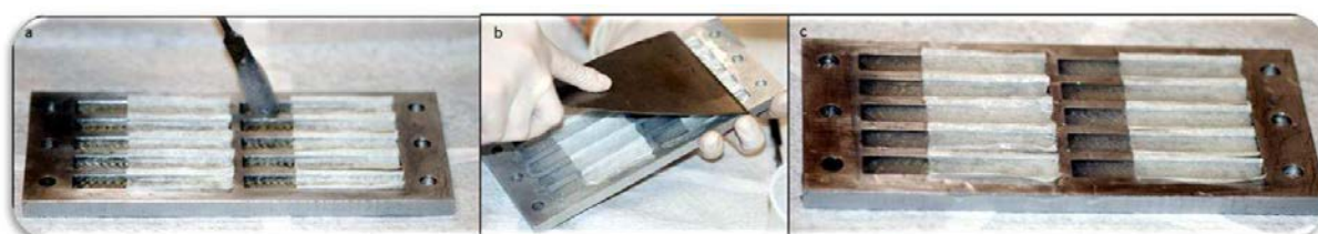
Figura 22: Confeção da porção de silicone: (a) Silicone sendo inserido no interior da matriz metálica, (b) regularização da superfície das amostras com auxílio de espátula metálica. (c) Aspecto das amostras previamente à polimerização do silicone.
