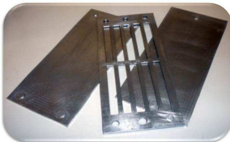
Figura 1: Matriz metálica utilizada para confecção das barras de resina acrílica. Constituída por três partes, sendo tampa, porção central, contendo dez aberturas com dimensões 75 X 10 X 3mm e fundo, e encaixes laterais para garantir a adaptação das três partes durante a prensagem.
