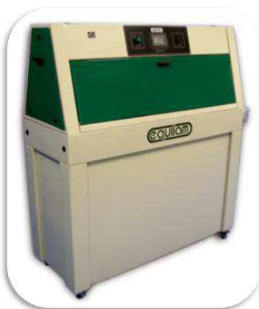
Figura 13: Câmara de envelhecimento acelerado para não-metálicos (Equilam, Diadema, SP, Brasil), utilizada para o ensaio de envelhecimento das amostras.
