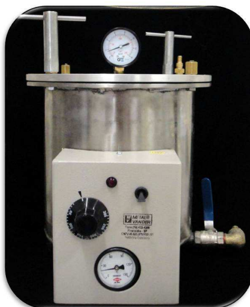
Figura 10: Polimerizadora de resina, utilizada durante a fase de polimerização da resina acrílica e do silicone facial, para evitar porosidade nos materiais.
