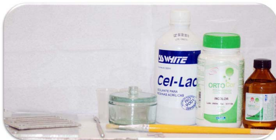
Figura 3: Materiais necessários para a confecção das barras de resina acrílica: Matriz metálica com tampa e fundo removível, Espátula metálica nº36, pote de resina com tampa, isolante para resinas acrílicas (Cel-Lac, S.S. White, Rio de Janeiro, RJ, Brasil), Pó e líquido da resina acrílica de ativação química Orto Cor pó e líquido (VIPI, Pirassununga, SP, Brasil) e pincel (Tigre, Rio Claro, SP, Brasil).
