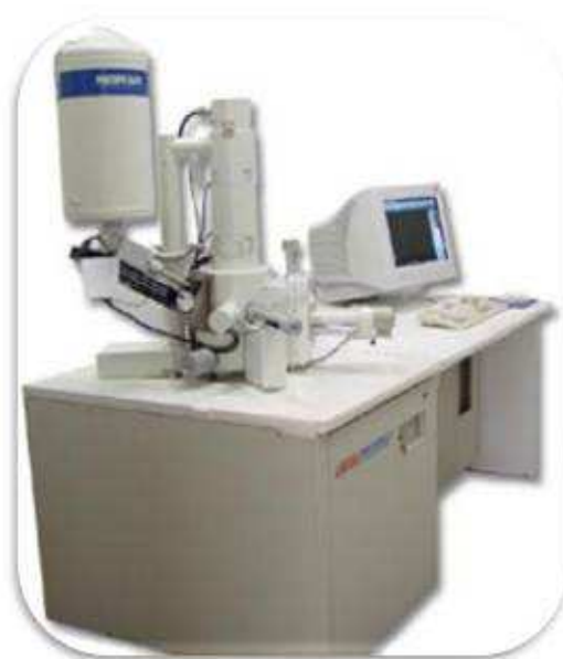
Figura 14: Microscópio Eletrônico de Varredura JSM 5600LV (Jeol, Tóquio, Japão), utilizado para análise e registro de imagem da interface resina acrílica-silicone facial.
