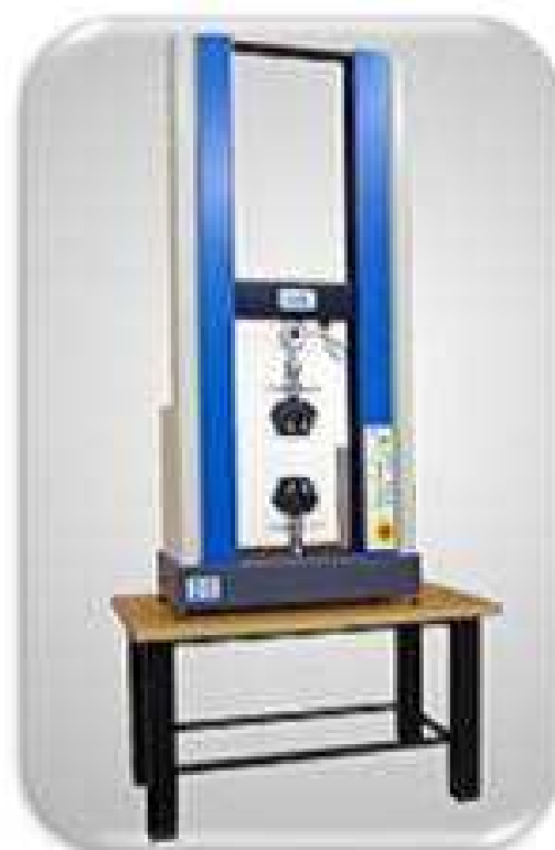
Figura 12: Máquina de Ensaio Universal (EMIC, EMIC DL 3000, São José dos Pinhais, PR, Brasil), utilizada na realização do teste de resistência de união.
