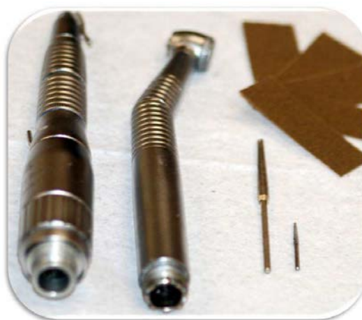
Figura 4: Materiais utilizados para acabamento das barras de resina acrílica e confecção de ranhuras: Micromotor, peça reta e caneta de alta rotação (KaVo, Biberach, Baden-Württemberg, Alemanha); tiras de lixa P220 (Tigre, Rio Claro, SP, Brasil); mandril para tiras de lixa e ponta diamantada nº2135 (KG Sorensen, Barueri, SP, Brasil).
