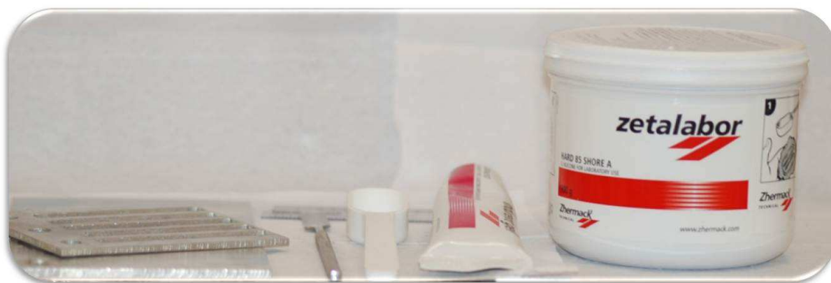
Figura 2: Materiais utilizados para confecção dos dispositivos de silicone laboratorial: Matriz metálica com tampa e fundo removível, régua, espátula n°36, Kit de silicone de condensação de uso laboratorial (colher de medida, Indurent Gel e Zetalabor, Zhermack, Badia Polesine, RO, Itália).
