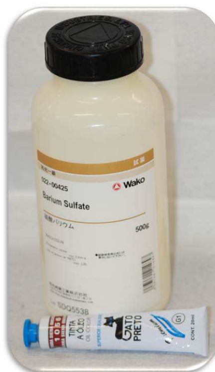
Figura 8: Materiais utilizados para pigmentação do silicone: Opacificador a base de Sulfato de Bário (Wako, Osaka, Osaka, Japão) e tinta a óleo (Gato Preto, Sorocaba, SP, Brasil).
