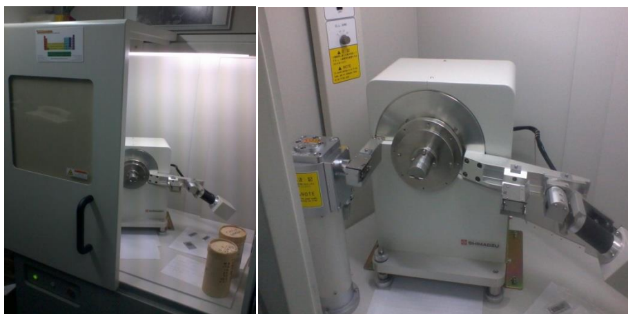
Figura 3.3 – XRD (modelo XRD-6000) utilizado para as caracterizações estruturais dos pós e dos filmes.
