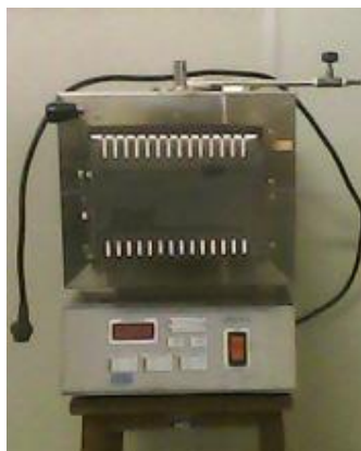
Figura 3.2 – Mufla de laboratório modelo EDG 3000, utilizada para os tratamentos térmicos (com máximo de temperatura em 1200°C).
