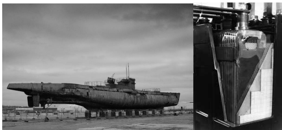
Figura 1.0 – Carcaça do U-Boat (à esquerda), o navio de guerra alemão aprimorado pelos estadunidenses devido à descoberta do Titanato de Bário e das baterias da XXI geração, para os electro-boats (à direita).
